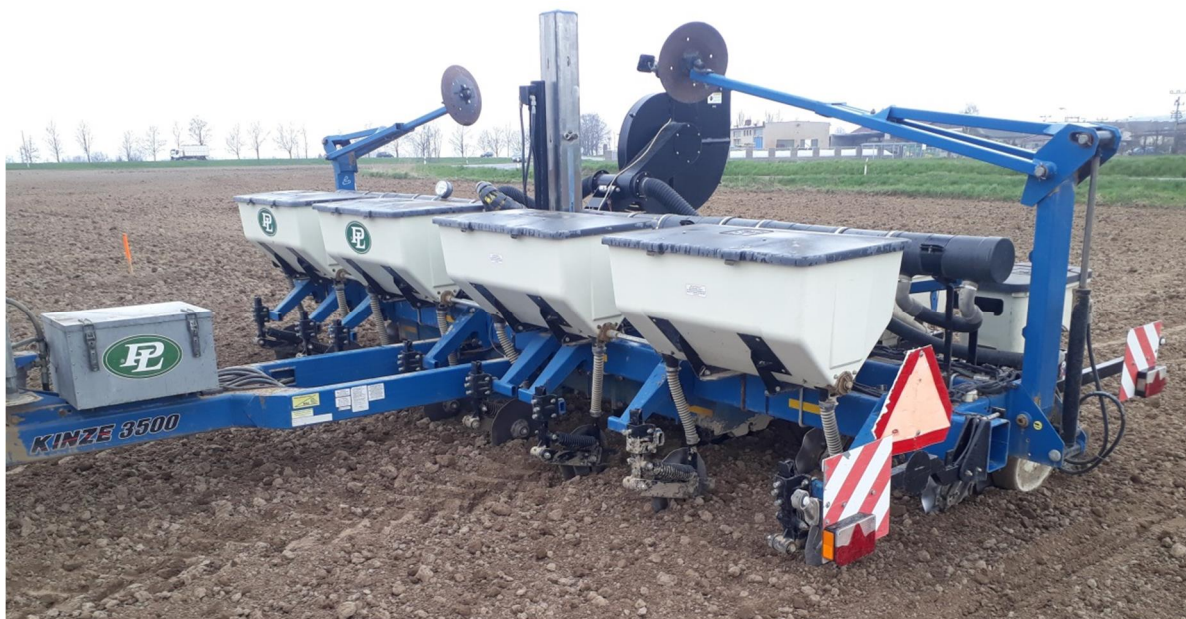
Obr. 11 Setí secím strojem KINZE 3500
