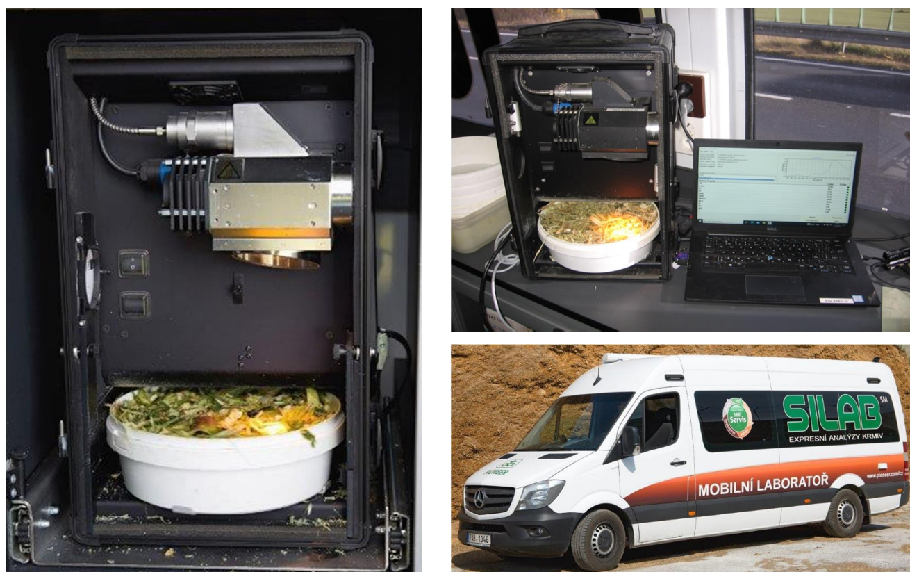
Obr. 8 Mobilní laboratoř pro vyhodnocení vzorků řezanky kukuřice
