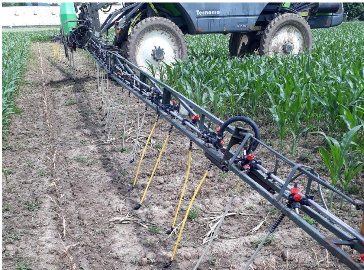
Obr. 12 Ukázka aplikace hnojiva DAM pomocí trubicových nástavců
