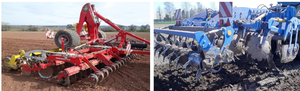
Obr. 9 Předseťová příprava Pöttinger Terradisc a Farmet Digger
