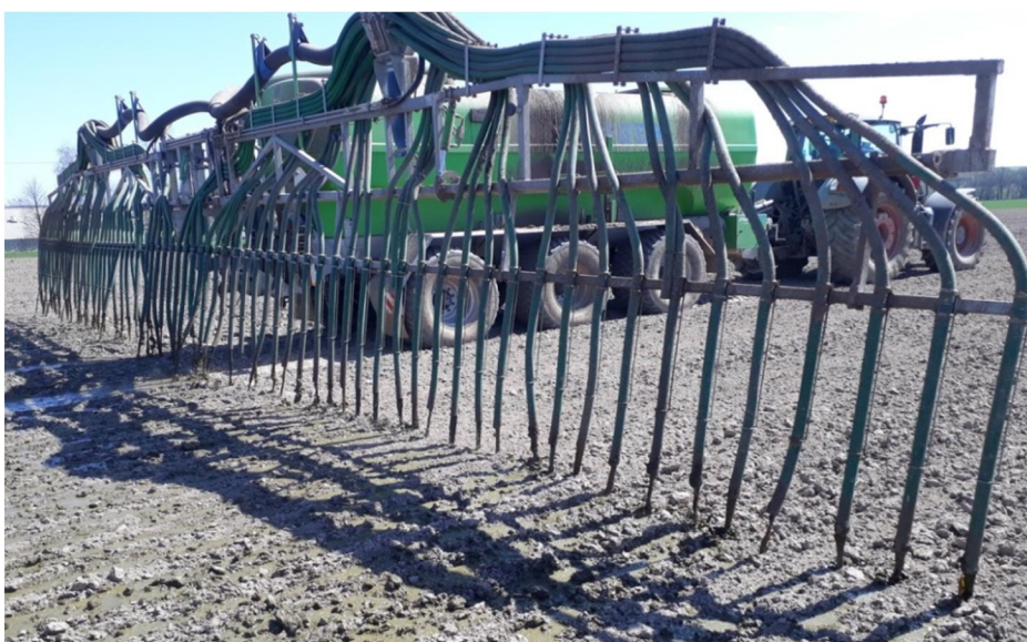
Obr. 10 Aplikace kejdy pomocí cisterny BAUER o objemu 24.000 l s hadicovým aplikátorem se záběrem 18 m
