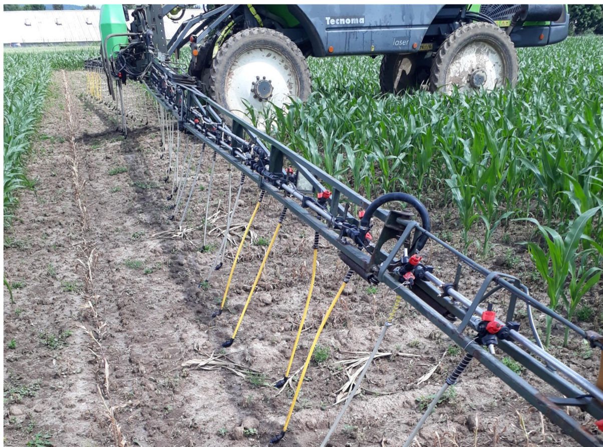
Obr. 12 Ukázka aplikace hnojiva DAM pomocí trubcových nástavců
