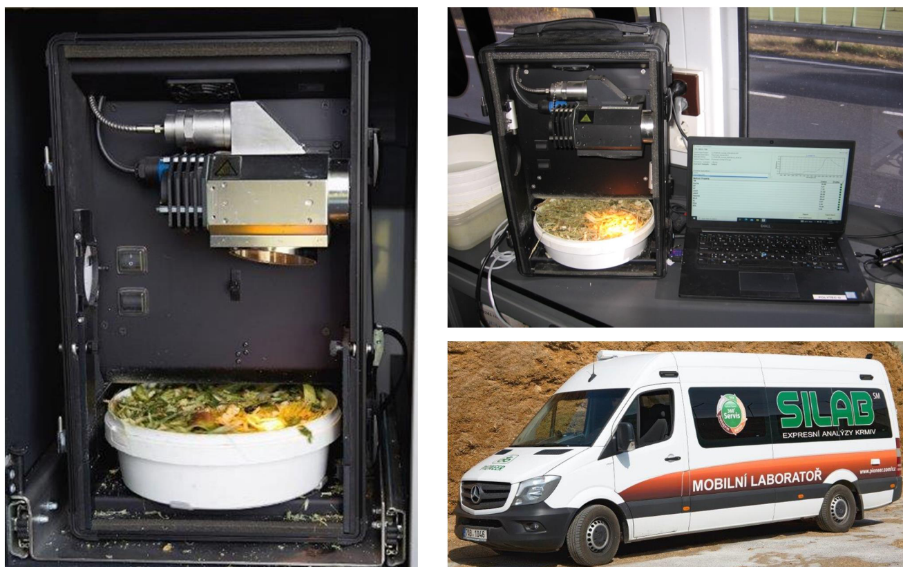
Obr. 8 Mobilní laboratoř pro vyhodnocení vzorků řezanky kukuřice
