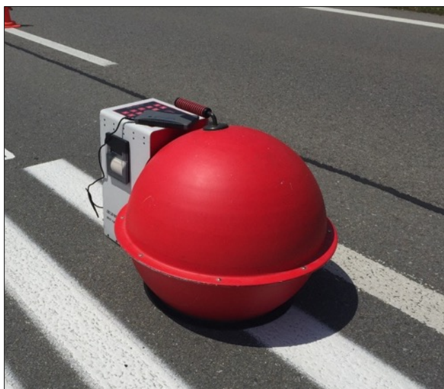
Obr. č. 11 Retroreflektometr QD 30 [vlastní]
