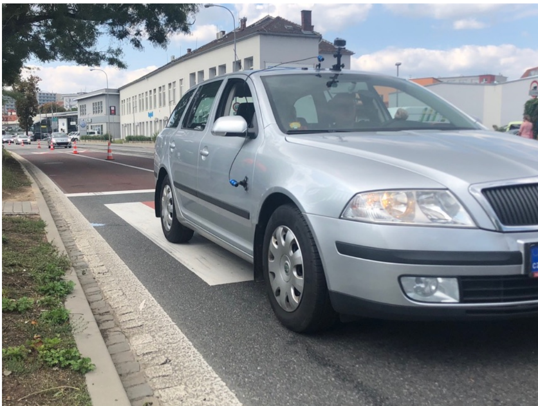
Obr. č. 10 Konečná poloha vozidla po brzděné zkoušce na přechodu pro chodce, směr křižovatka, suchý povrch, září 2018 [vlastní]
