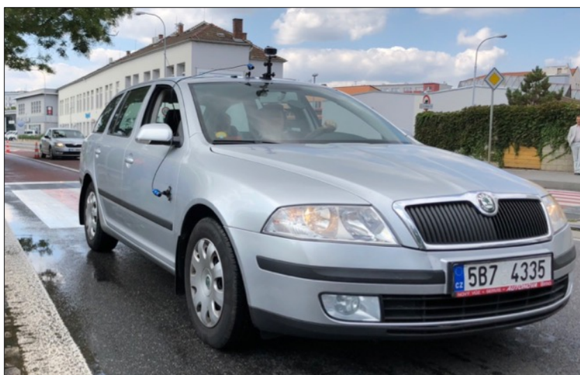
Obr. č. 42 Umístění kamer při měření na vozidle [vlastní]
