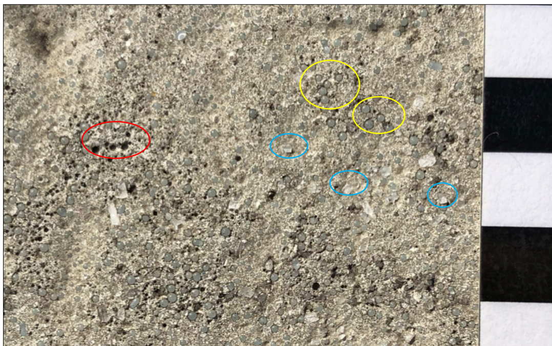
Obr. č. 65 Detail vzorku TPPz 1, žlutě označená zůstávající balotina, červeně označená vydrolená balotina a modře protismykové přísady, duben 2019 [vlastní]
