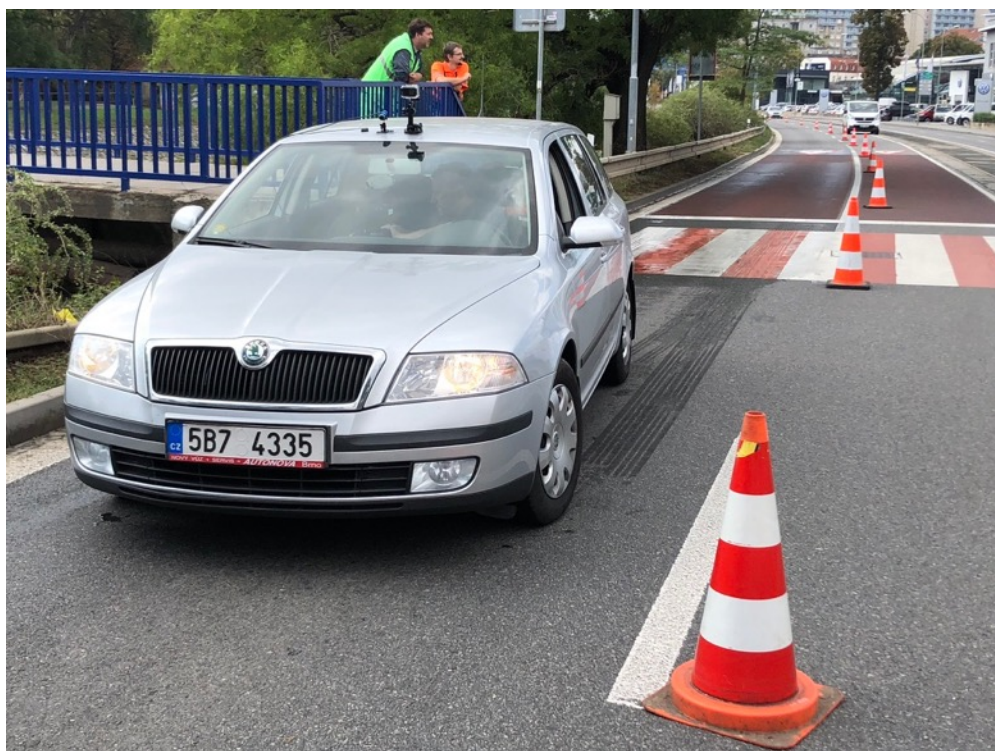
Obr. č. 12 Konečná poloha vozidla po brzděné zkoušce na přechodu pro chodce, směr křižovatka, mokrý povrch bez ABS, září 2018 [vlastní]
