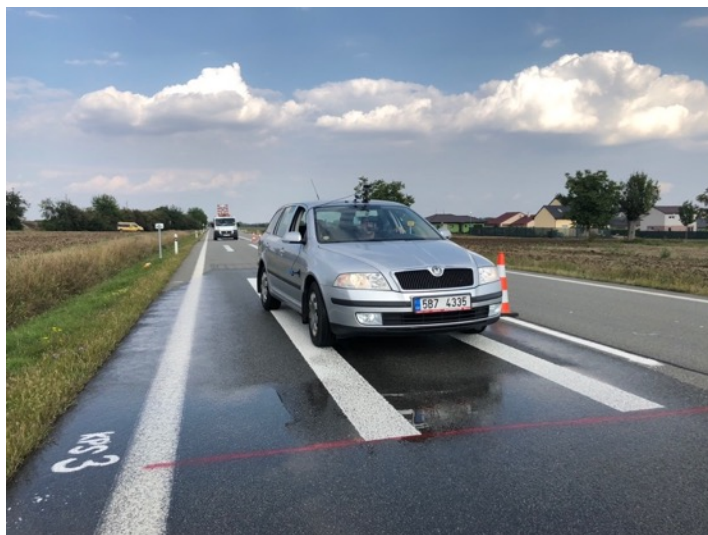
Obr. č. 3 Konečná poloha vozidla po brzděné zkoušce na vzorku KPS 3, září 2018 [vlastní]
