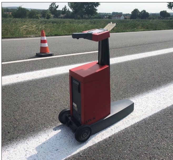
Obr. č. 10 Retroreflektometr LTL – X [vlastní]
