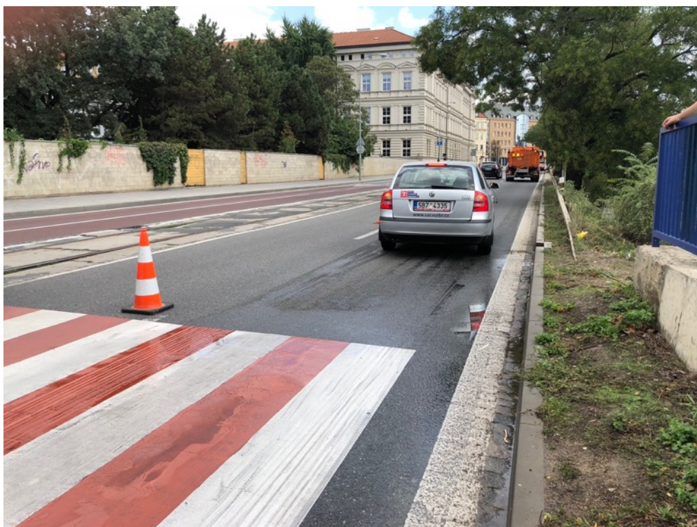
Obr. č. 13 Konečná poloha vozidla po brzděné zkoušce na přechodu pro chodce, směr křižovatka, mokrý povrch bez ABS, září 2018 [vlastní]
