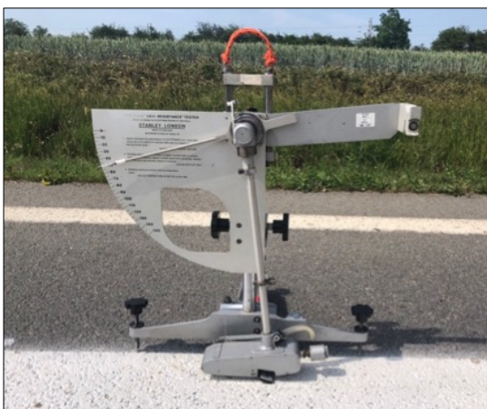
Obr. č. 12 Kyvadlový přístroj TRRL [vlastní]
