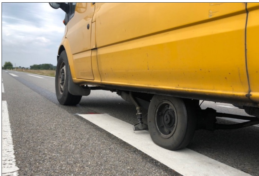
Obr. č. 30 Pohled na měřicí pneumatiku a trysku ke smáčení měřeného povrchu [vlastní]
