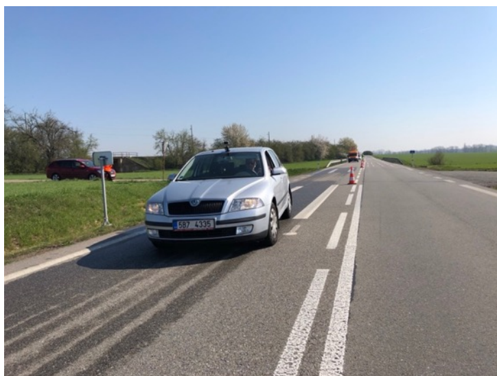
Obr. č. 4 Konečná poloha vozidla po brzděné zkoušce na vzorku TP 6, duben 2019 [vlastní]
