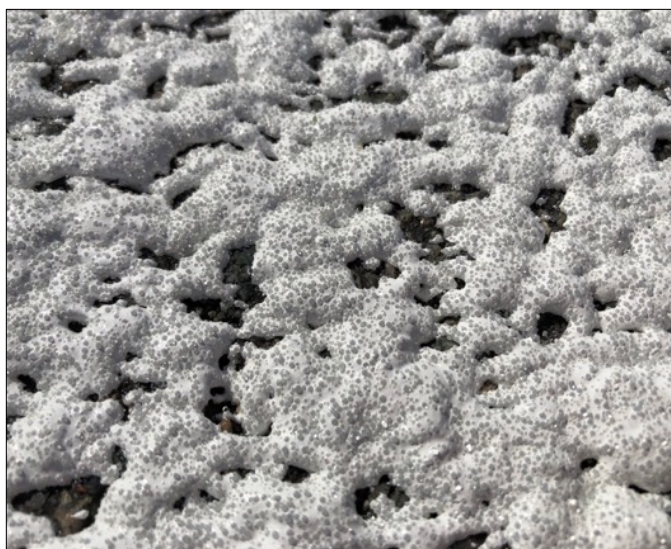
Obr. č. 54 Detail vzorku KPS 3 - zrna balotiny [vlastní]
