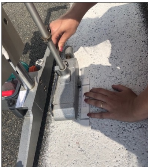
Obr. č. 27 Nastavení prokluzu třecí patky kyvadla před začátkem měření [vlastní]
