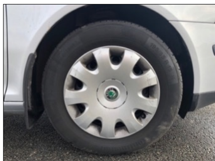
Obr. č. 43 Pohled na pneumatiky použité při provádění brzděné zkoušky – Continental, ContiPremium Contact 5, 195/65 R 15 [vlastní]
