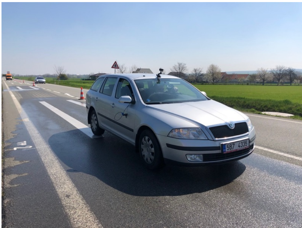
Obr. č. 1 Konečná poloha vozidla po brzdné zkoušce na vzorku TPP 2, duben 2019 [vlastní]
