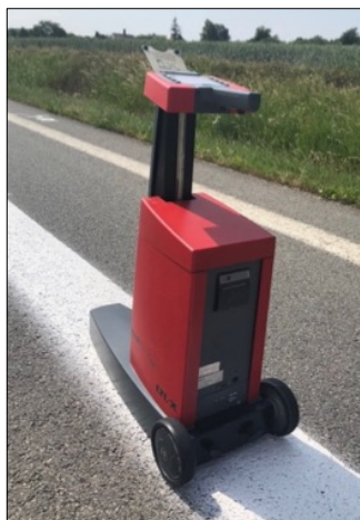
Obr. č. 45 Retroreflektometr LTL - X [vlastní]
