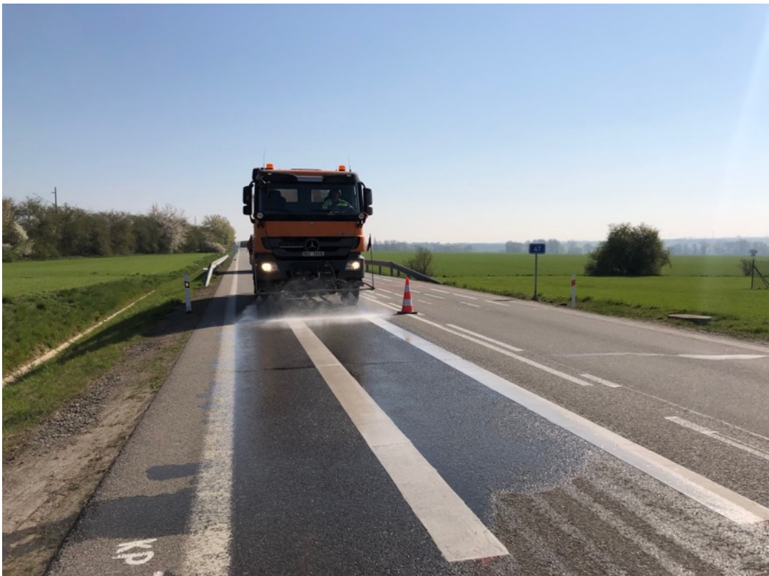
Obr. č. 7 Skrápění povrchu před prováděním brzdné zkoušky na mokřém povrchu (s ABS, bez ABS), duben 2019 [vlastní]
