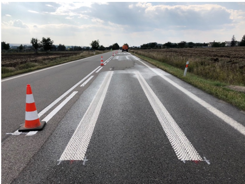
Obr. č. 8 Brzdné stopy po brzdě zkušce za mokra bez ABS na vzorku TP 6, září 2018 [vlastní]
