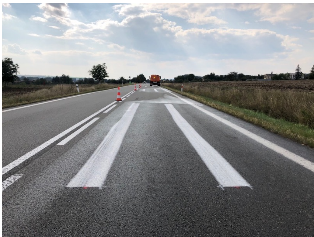
Obr. č. 9 Brzdné stopy po brzdě zkušce za mokra bez ABS na vzorku RB 4, září 2018 [vlastní]
