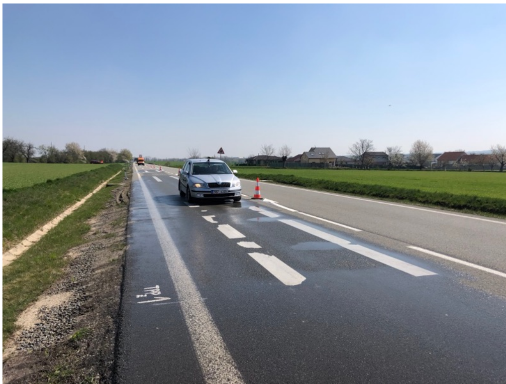
Obr. č. 2 Vozidlo při brzdné zkoušce na vzorku TPPz 1, duben 2019 [vlastní]
