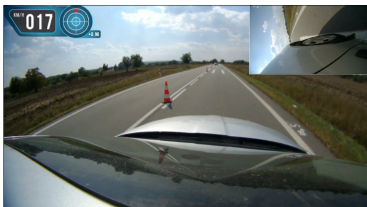
Obr. č. 63 Snímek z videozáznamu brzdné zkoušky na vzorku RBp 5 - suchý [vlastní]
