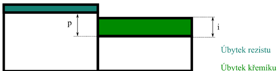
Obrázek 6.5: Schéma řezu křemíkovým waferem. Vzdálenost p měří profilometr. Vzdálenost i měří interferometr.
