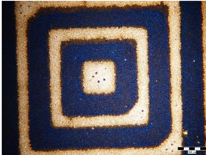
Obr. 2.4: Ukázka leptaného obrazce „Reimer“. Leptací pasta aplikována pomocí sítotisku. [39]
