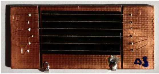
Obr. 4.67: Vzorek na nosném DPS. Přední kontakt je vyveden na boční-izolované části. Zadní kontakt článku je vodivě přemostěn na zadní stranu oboustranného DPS. Fotografie. Rozměry podložky 55x20 mm. Rozměry článku cca 30x12 mm.
