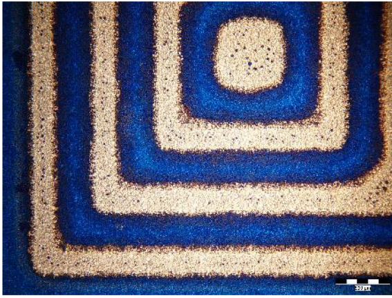
Obr. 2.30: Vyleptaný motiv „Reimer“ do nitridové masky. [7]
