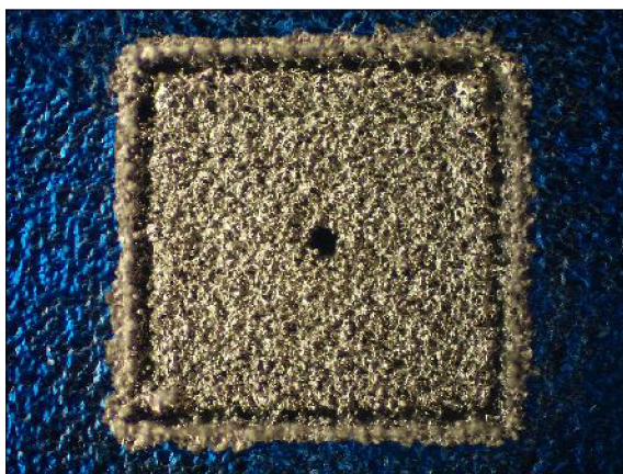
Obr. 4.28: Kontaktní ploška s jedním prokovem – po depozici základní Ni vrstvy. Rozměry plošky 560x560 \mu\text{m} . Průměr díry 35 \mu\text{m} .
