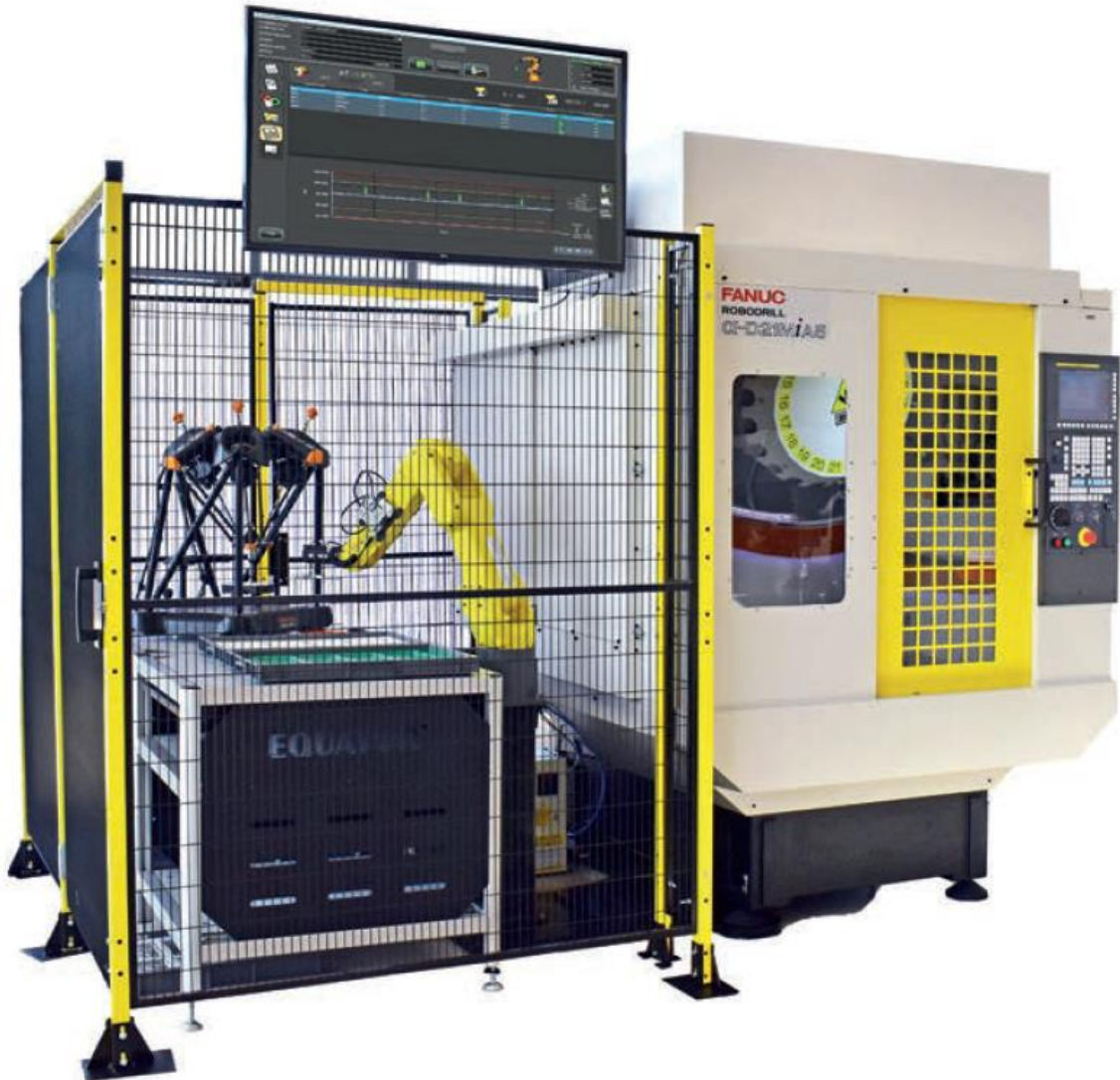
Obr. 18 Možné využití manipulačního robotu a systému Equator [19].
