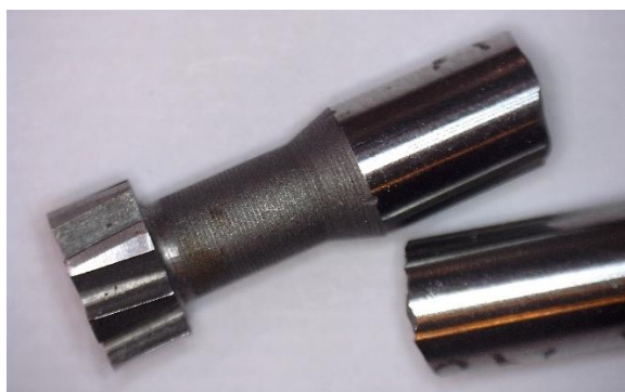
Obr. 16 Zlomená korunková fréza Ø10.
