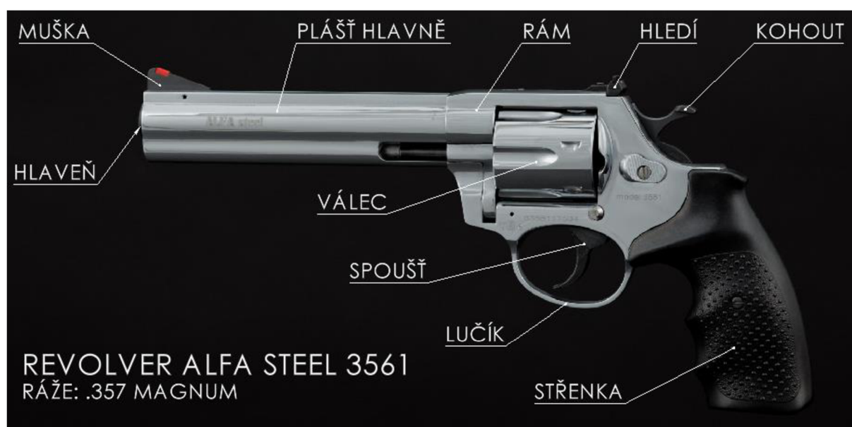
Obr. 2 Revolver s rozlišením hlavních částí [3].
