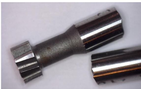
Obr. 16 Zlomená korunková fréza Ø10.
