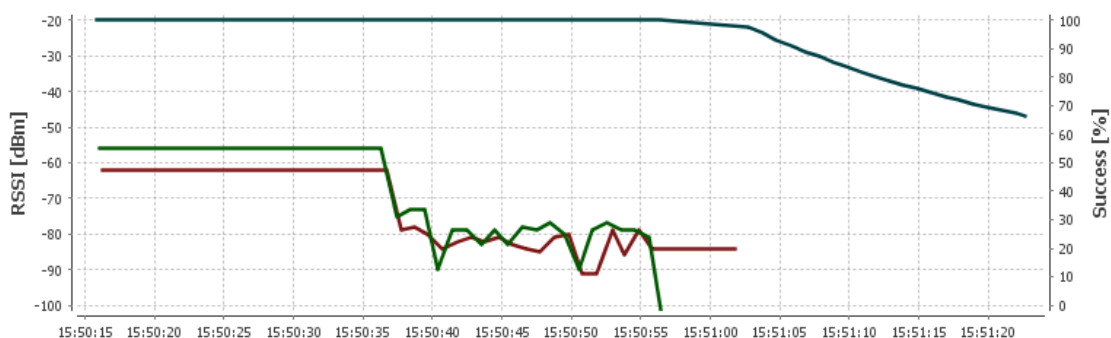
Obr. 5.3: Test přenosu dat 1mW, 3m
