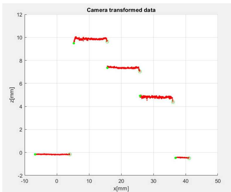
Obrázek 3.29 Výsledky měření s teleobjektivem pro schodovitý objekt
