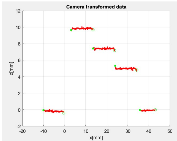
Obrázek 3.14 Výsledek měření variantou s pevnou pozicí zrcadla se schodovitým objekt pro přímý záběr
