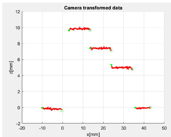
Obrázek 3.14 Výsledek měření variantou s pevnou pozicí zrcadla se schodovitým objektem pro přímý záběr
