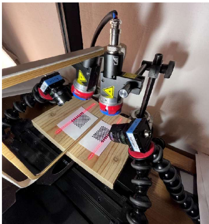
Obrázek 3.2 Navržený měřicí systém se zrcadlem na platformě
