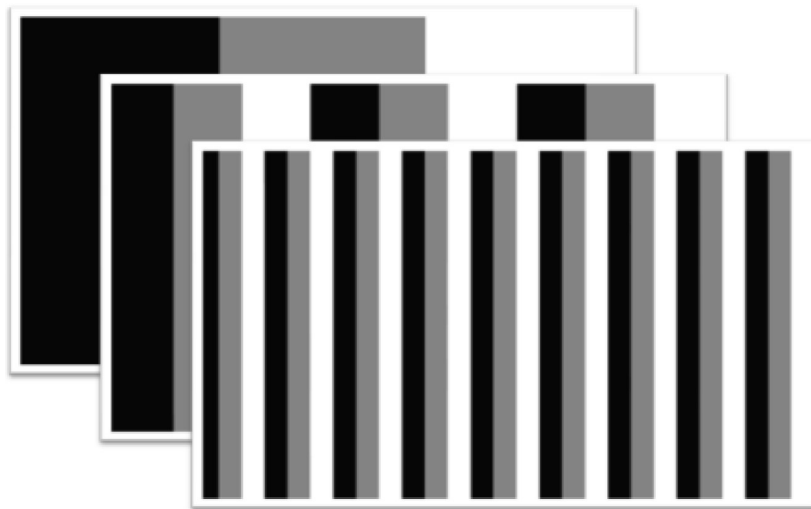
Obrázek 2.28 Aktivní triangulace s projekcí vzorů s pruhy v odstínech šedi [20]
