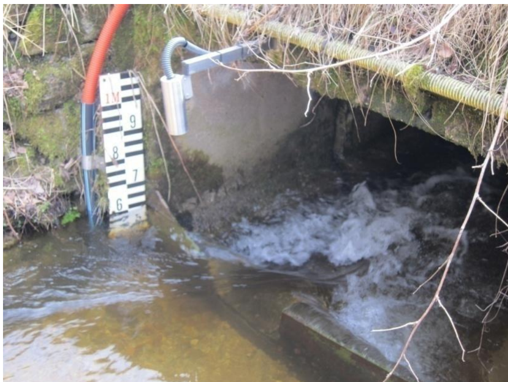
Foto č.1. Závěrný profil povodí Horského potoka s automatickým měřením výšky hladiny (ultrazvuk), vodivosti a teploty vody. (foto: Procházka, 2012).
