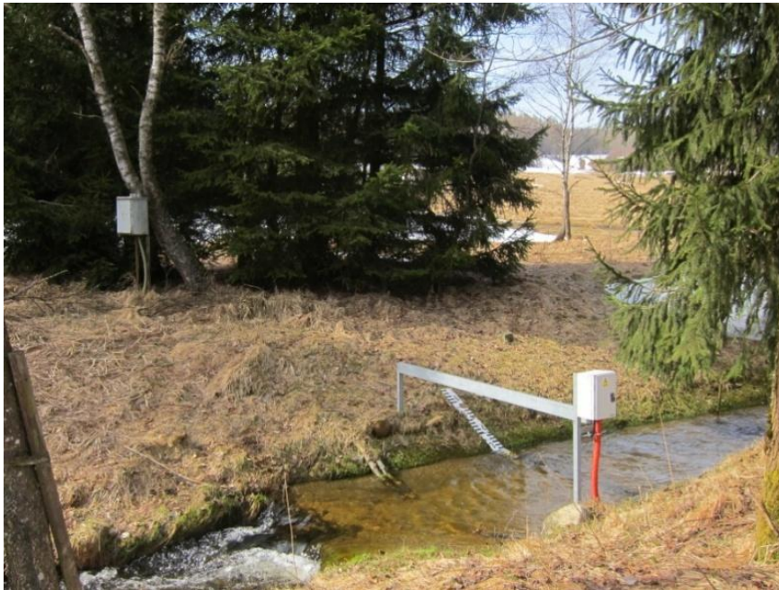
Foto. č. 2. Závěrný profil povodí Mlýnského potoka s automatickým měřením výšky hladiny (ultrazvuk), vodivosti a teploty vody (foto: Procházka, 2012).
