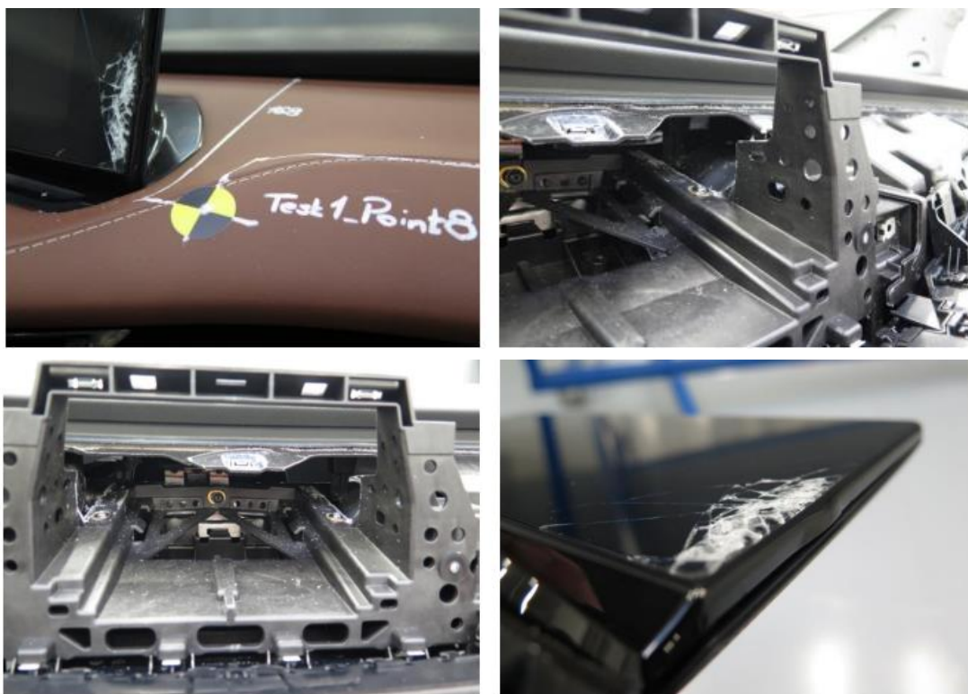
Obr. II Přístrojová deska po zkoušce číslo 1 – zdroj autor
