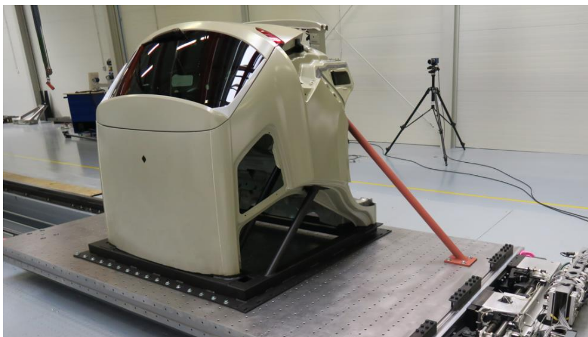
Obr. 6 Zkouška pevnosti upevnění dveří – zdroj autor
