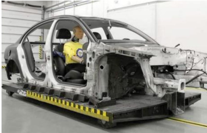
Obr. 60 Saňová zkouška (urýchlovací vozík) (46)
