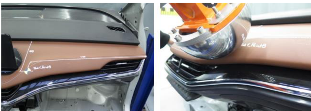
Obr. I Přístrojová deska před zkouškou číslo 1 – zdroj autor
