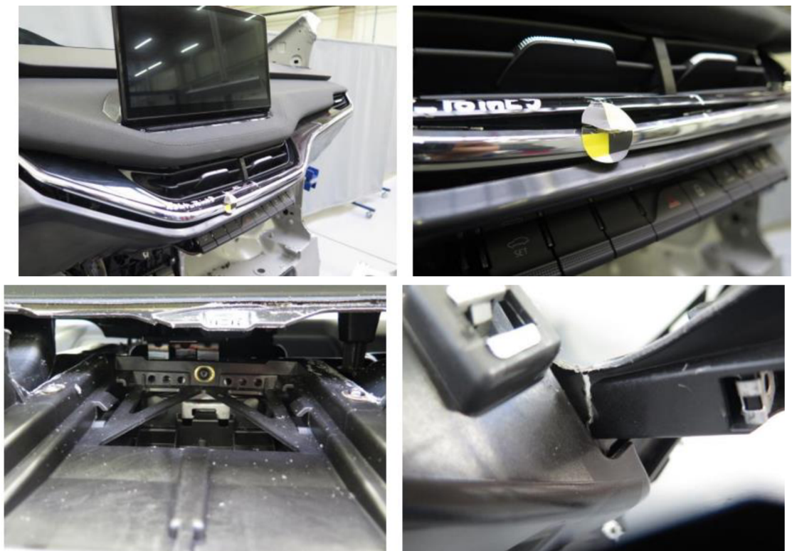
Obr. V Přístrojová deska po zkoušce číslo 4 – zdroj autor
