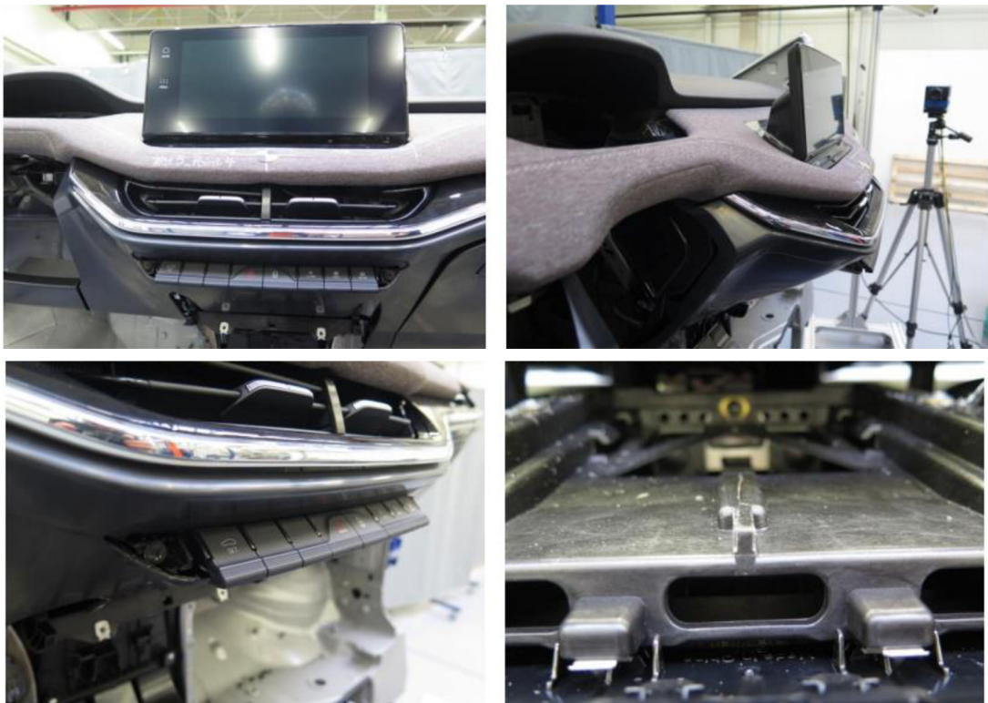
Obr. VII Přístrojová deska po zkoušce číslo 5 – zdroj autor
