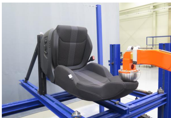
Obr. 79 Zkouška pohlcení energie hlavové opěrky zepředu – zdroj autor
