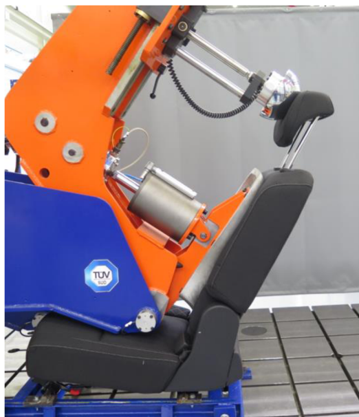
Obr. 76 Zkušební zařízení pro testování opěradla a hlavové opěrky – zdroj autor
