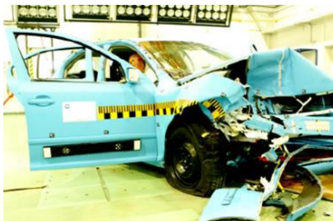
Obr. 14 Testované vozidlo po zkoušce čelního nárazu – zdroj autor
