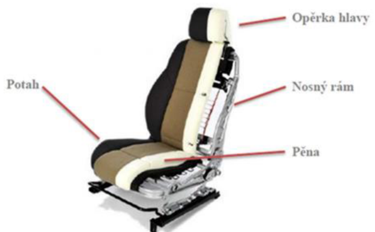
Obr. 33 Čtyři hlavní konstrukční prvky sedadel (sedadlo přední) (31)
