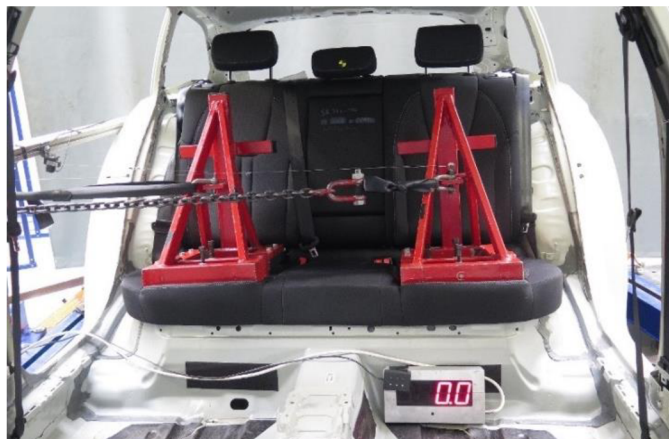
Obr. 11 Zatížení šikmé – zdroj autor
