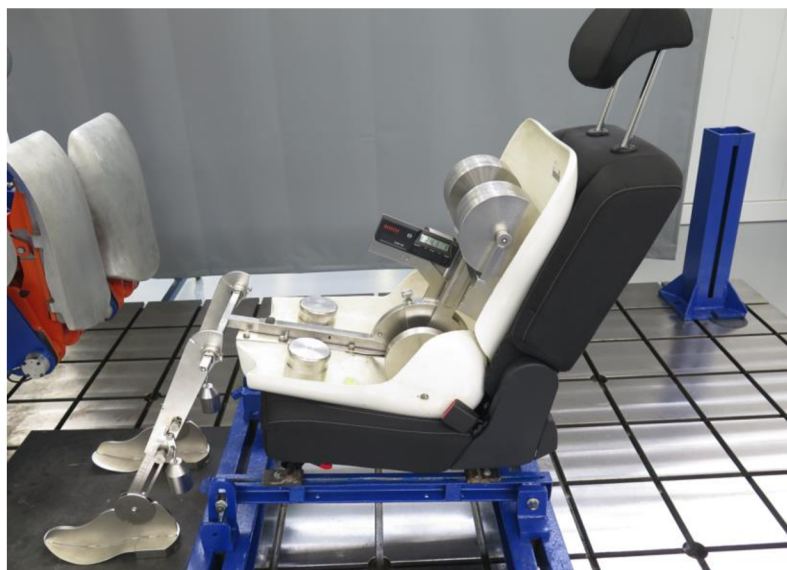
Obr. 73 Zařízení 3DH – zdroj autor
