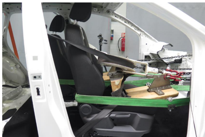
Obr. 8 Statická zkouška dle OSN č.14 – zdroj autor
