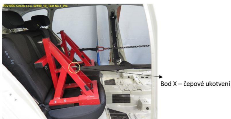
Obr. 10 Zatížení směrem dopředu – zdroj autor
