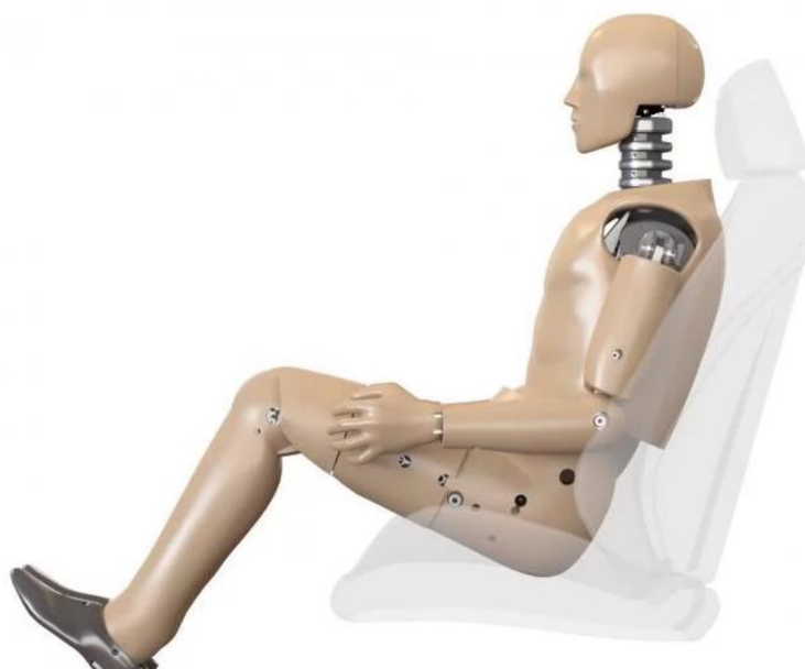
Obr. 16 Figurína HIBRID 3. 50-ti percentilního muže (47)
