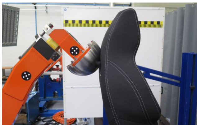
Obr. 77 Zkouška pohlcení energie opěradla sedačky zezadu – zdroj autor
