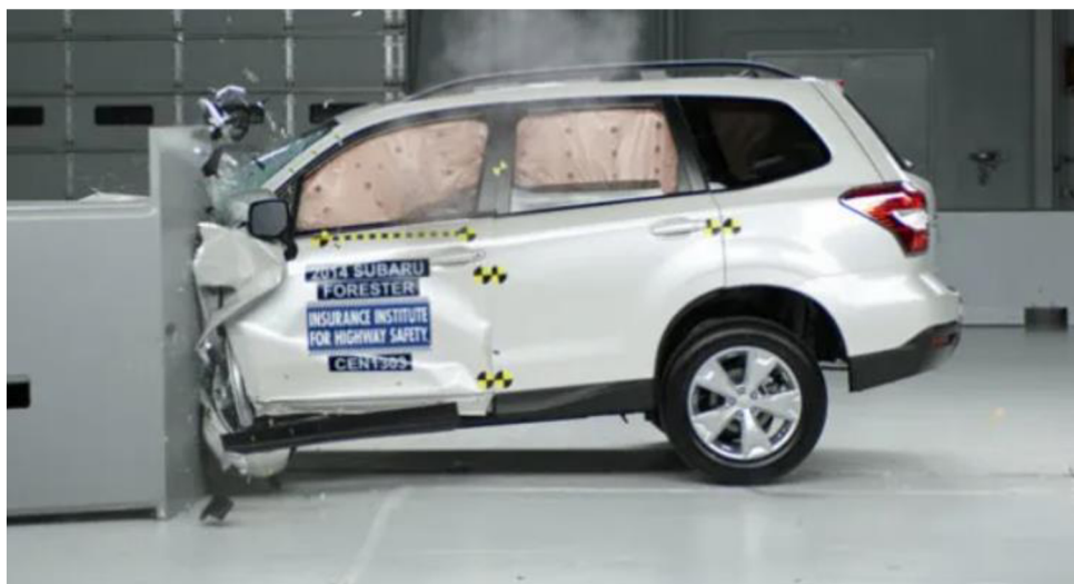
Obr. 59 Zkouška čelního nárazu (45)
