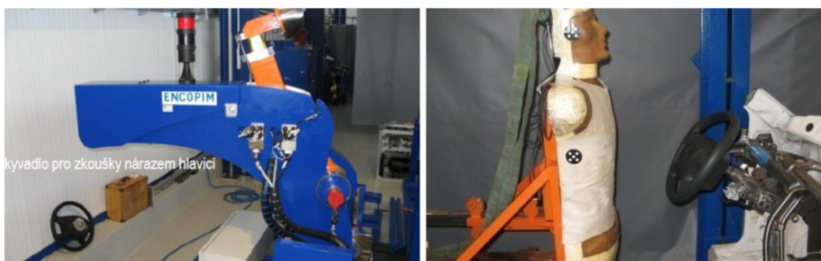
Obr. 7 Ukázka zkoušky nárazem zkušební hlavici a náraz torzem – zdroj autor
