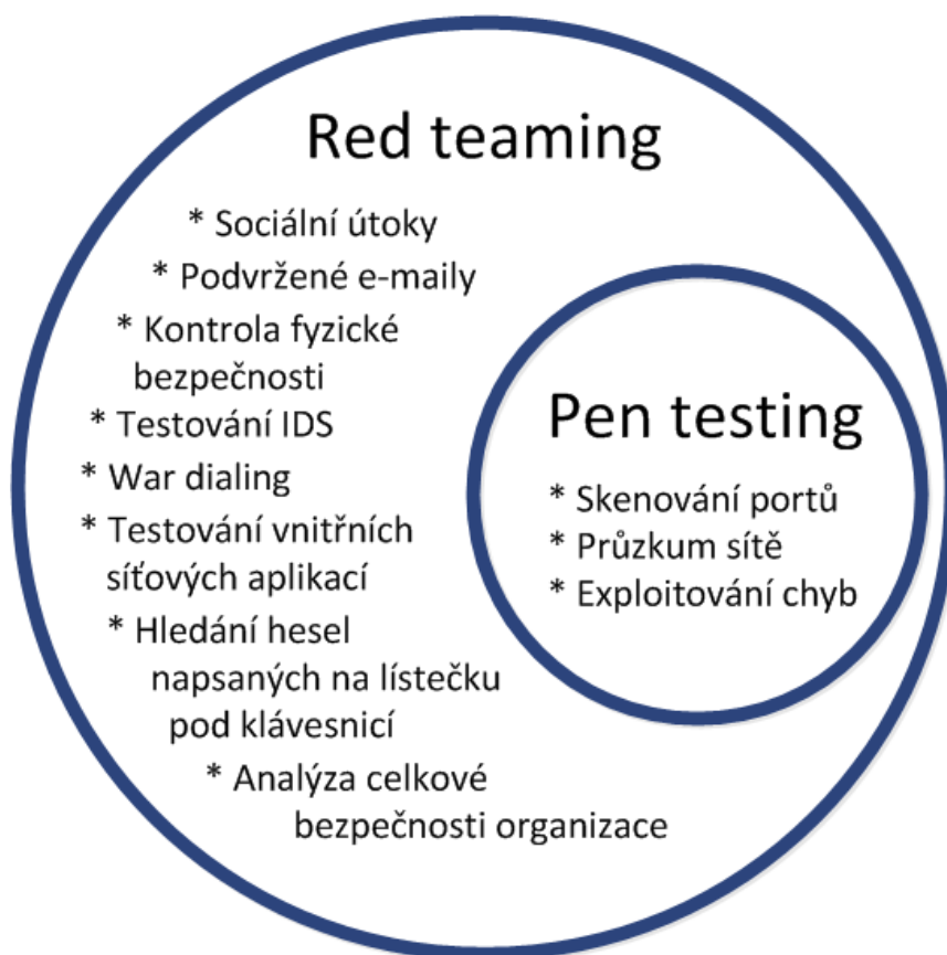
Obr. 1: Red teaming a pen testing. Zdroj: upraveno autorem dle (Harris et al., 2008, s. 84).
