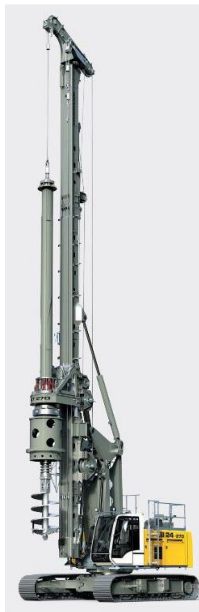
Obrázek 39 – Vrtná souprava Liebherr LB 24 [17]
