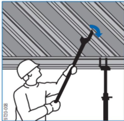
Obrázek 58 – Demontáž mezilehlých sekundárních nosníků [25]
