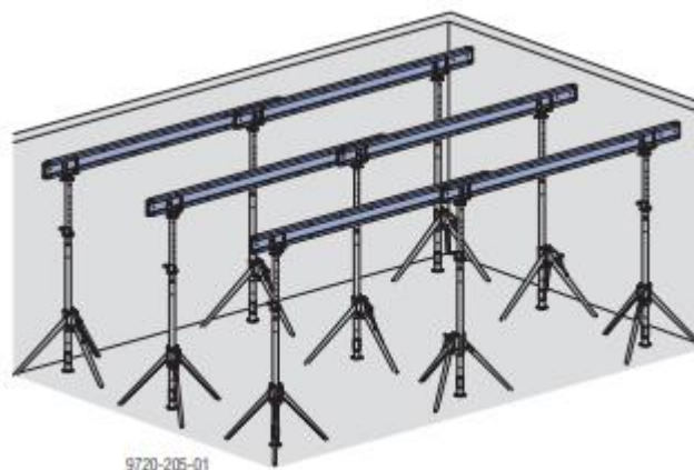
Obrázek 52 – Rozmístění primárních nosníků [25]
