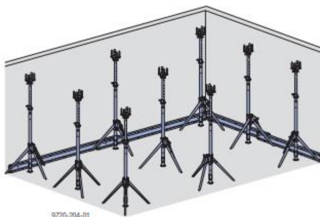
Obrázek 51 – Rozmístění podpěr s trojnožkou [25]
