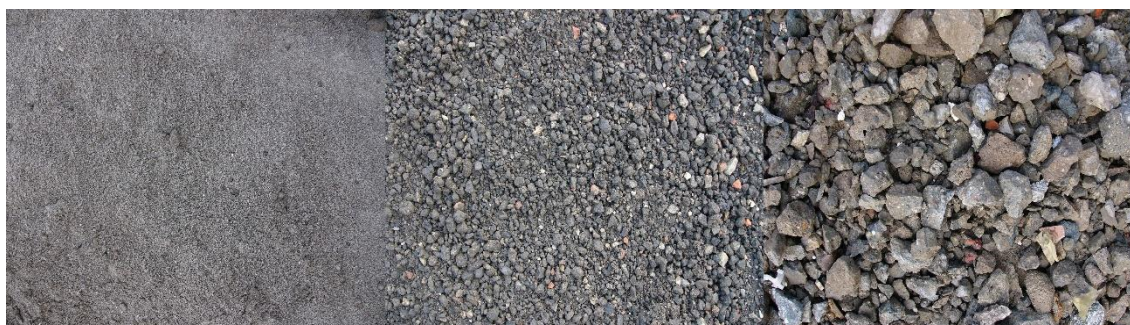
Obrázek 3: Ukázka frakcí z betonu
