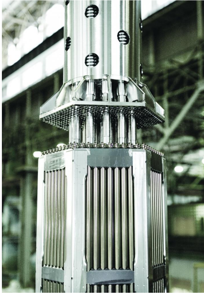
Obr. 2-3: Horní část palivového souboru pro reaktor VVER-1000, převzato z [11]
