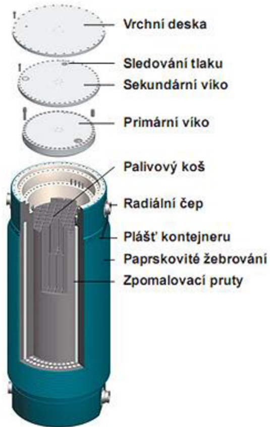
Obr. 3-4: Obalový soubor CASTOR 440/84M s popisem jednotlivých částí, převzato z [18]
