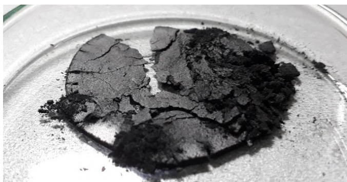
Obr. 4.27: Částečně rozpadlá peleta Batch 2 po vystavení mikrovlnnému záření
