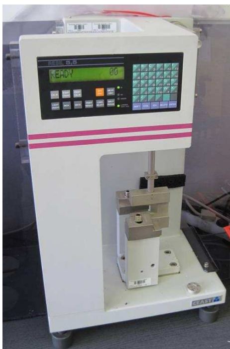
Obr. 15: Zkušební zařízení Resil 5.5
