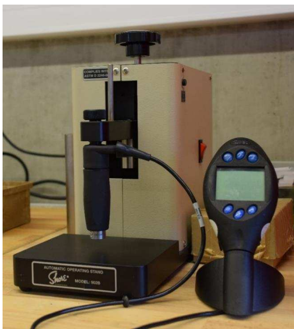
Obr. 13: Tvrdoměr Shore D s příslušenstvím.
