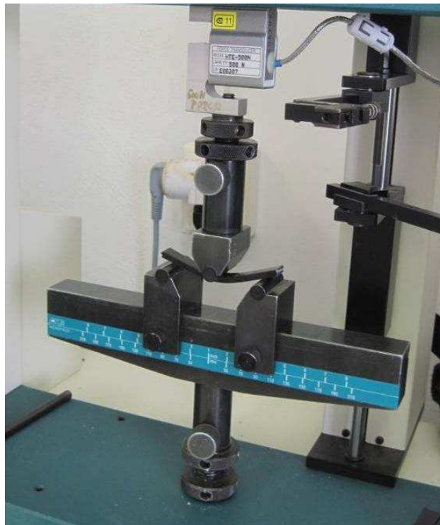
Obr. 12: Nástavec na měření ohybových vlastností na zařízení Hounsfield H10KT
