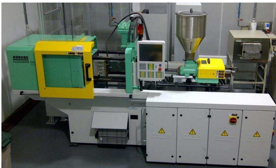
Obr. 11: vstřikovací stroj Arburg 270S 400-100
