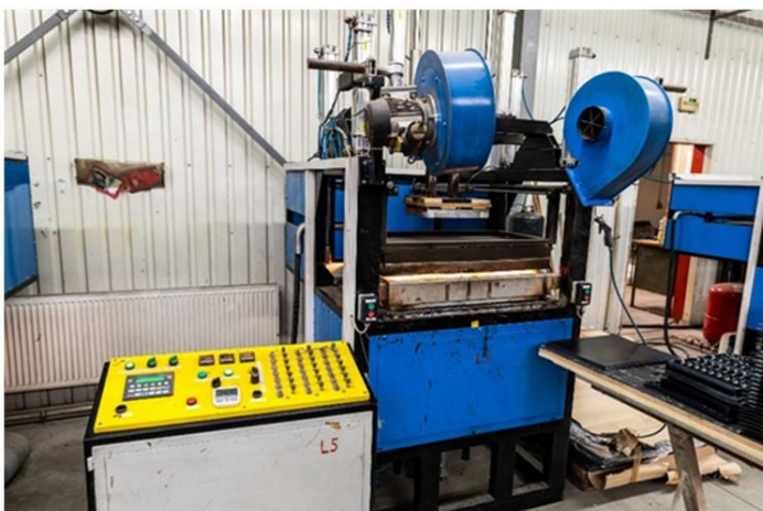
Obrázek 6 Stroj na zpracování plastových výlisků metodou vakuového tvářením [10][autor]
