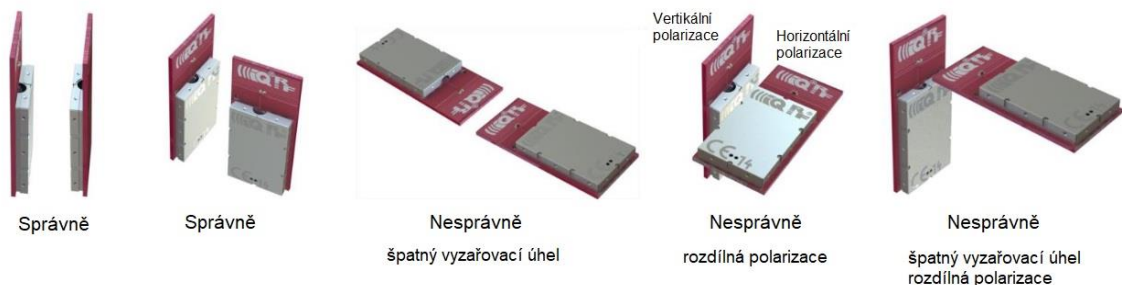
Obrázek 13 Příklady správných a nesprávných uspořádání párů TR-72DA [26]
