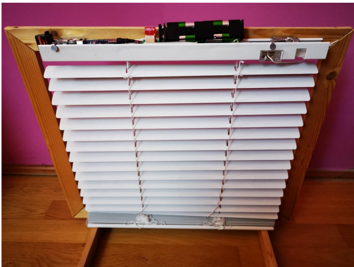
Obrázek 44 Maketa okna s nainstalovaným systémem řízení žaluzií; zleva – servomotor, Arduino Nano, IQRF transceiver, akumulátor [autor]
