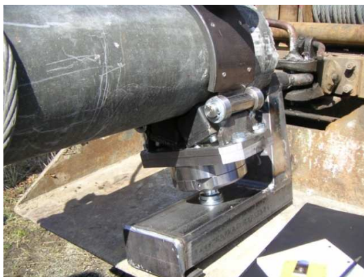
Obr. 9) První prototyp traktorového svěracího závěsu Pillar [10]
