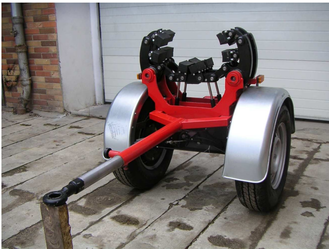
Obr. 7) První prototyp vozíku pro převoz betonových sloupů značky Pillar [10]
