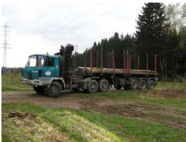
Obr. 2) Tahač s návěsem používaný pro převoz betonových sloupů [12]
