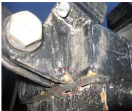
Obr. 108) a 109) Reálné poškození spodního sedla [vlastní foto]
