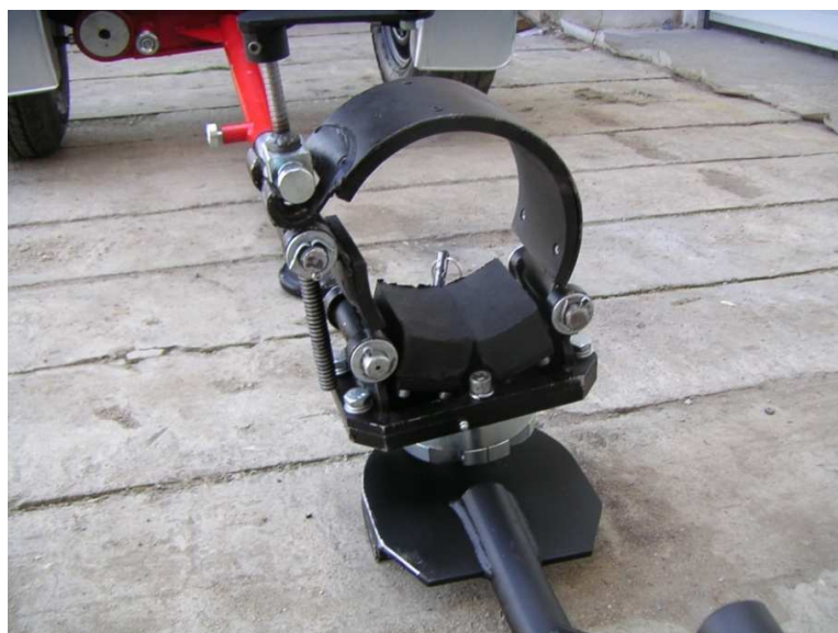
Obr. 11) První prototyp traktorového svěracího závěsu Pillar [10]
