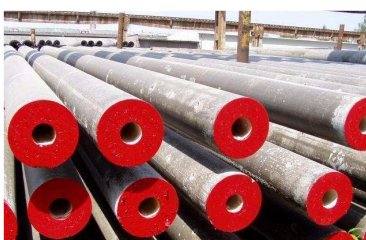
Obr. 12) Červené značení betonového sloupu (10,0 kN) [11]
