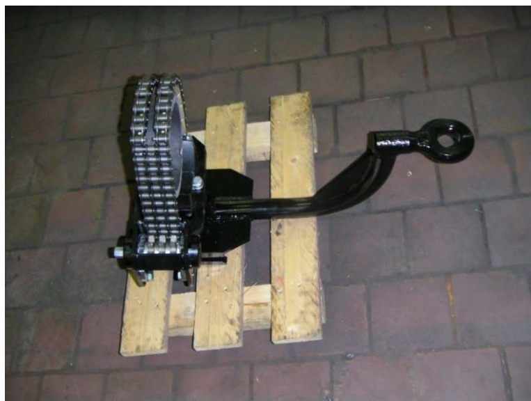
Obr. 10) Používaný prototyp traktorového svěracího závěsu Pillar [10]
