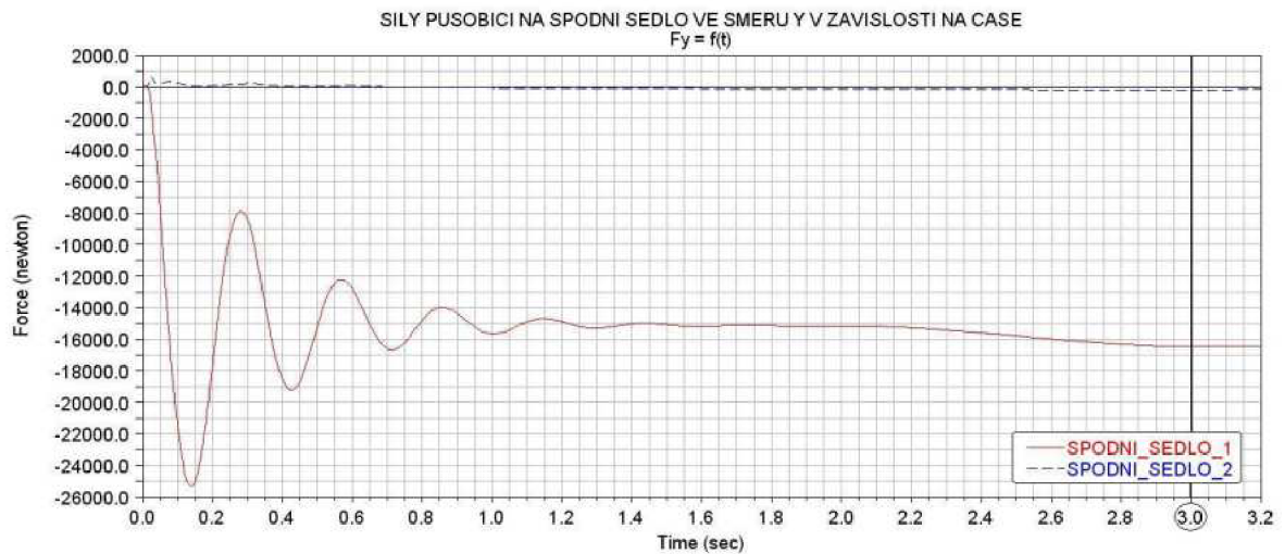
Obr. 65) Graf sil působících na spodní sedlo ve směru Y v závislosti na čase
