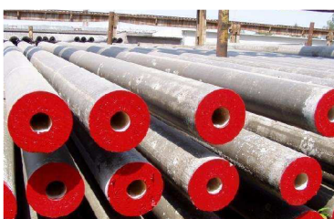
Obr. 12) Červené značení betonového sloupu (10,0 kN) [11]
