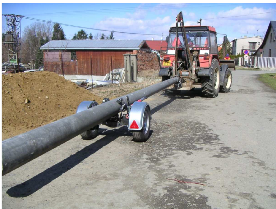
Obr. 1) Zařízení pro převoz betonových sloupů značky Pillar [10]
