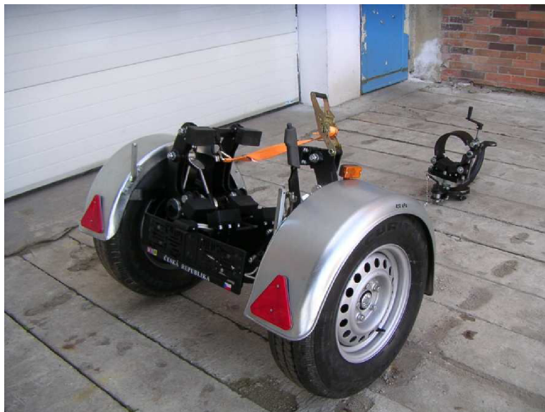
Obr. 8) Používaný vozík pro převoz betonových sloupů značky Pillar [10]
