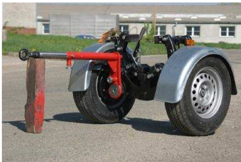
Obr. 16) Vozík pro přepravu betonových sloupů značky Pillar [10]
