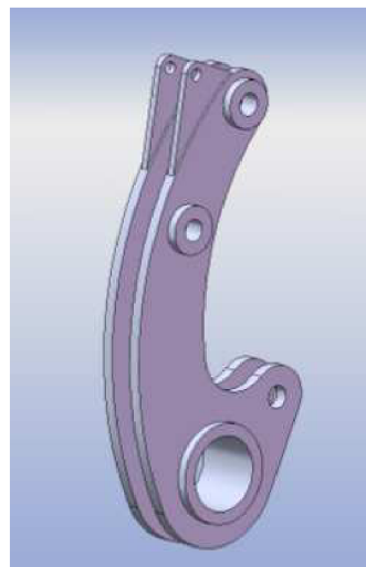
Obr. 27) Zjednodušený tvar svěracího ramene 3
