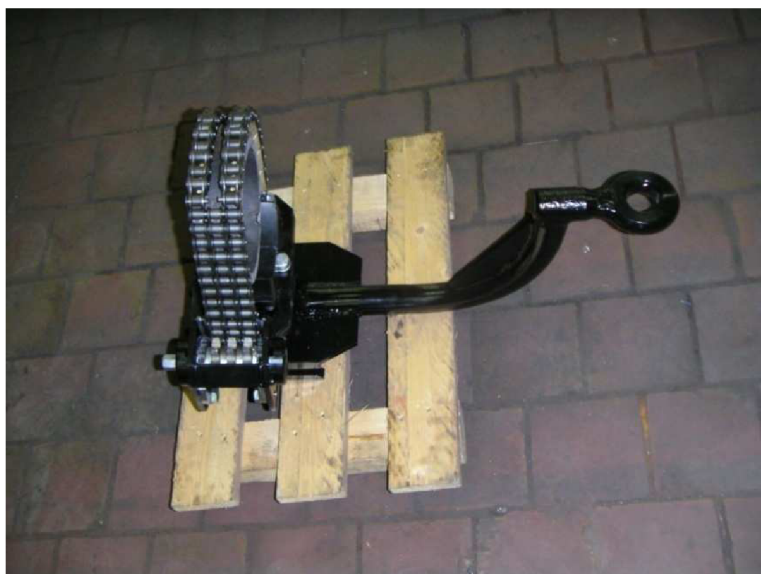
Obr. 10) Používaný prototyp traktorového svěracího závěsu Pillar [10]
