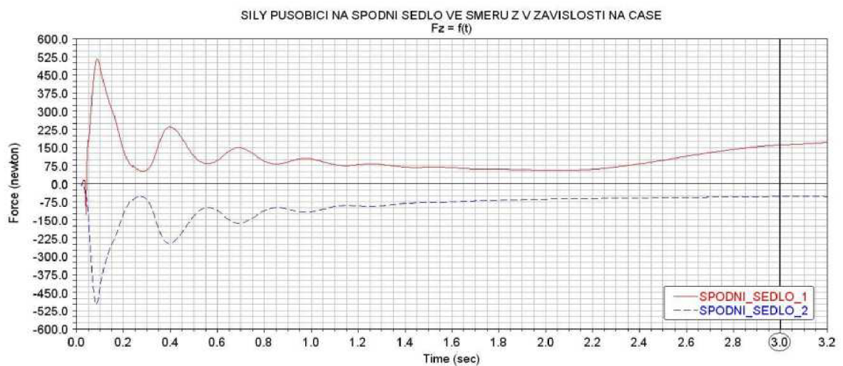
Obr. 66) Graf sil působících na spodní sedlo ve směru Z v závislosti na čase
