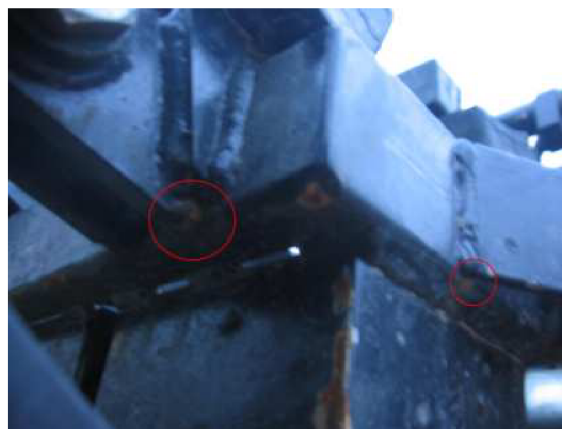
Obr. 108) a 109) Reálné poškození spodního sedla [vlastní foto]
