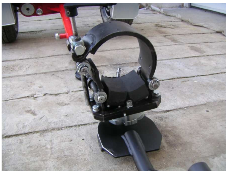
Obr. 11) První prototyp traktorového svěracího závěsu Pillar [10]
