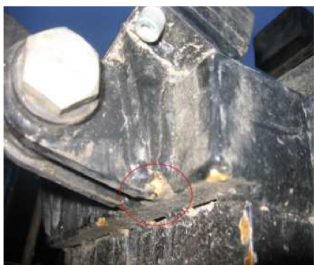
Obr. 108) a 109) Reálné poškození spodního sedla [vlastní foto]
