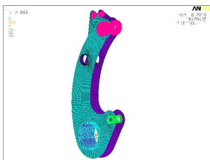
Obr. 84) Vlevo, výpočtový model svěracího ramene 3
