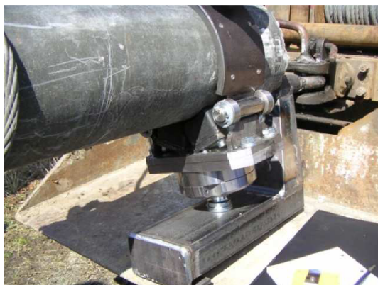
Obr. 9) První prototyp traktorového svěracího závěsu Pillar [10]
