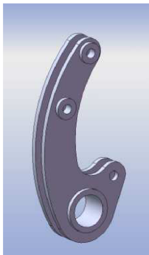
Obr. 26) Zjednodušený tvar svěracího ramene 1 a 2
