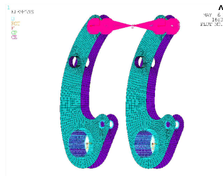
Obr. 85) Vpravo, výpočtový model svěracích ramen 1, 2
