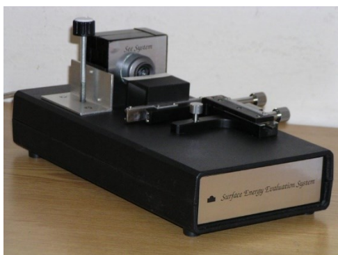
Obr. 20: Stolek s CCD kamerou a posuvem
