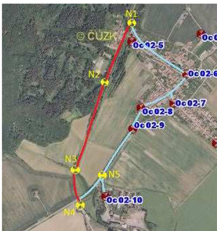
Obr. 6.3 Přehledná situace nivelačního měření [26]
