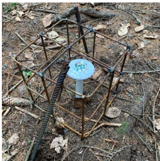
Obrázek 4.11– Detail na zabezpečení senzoru ochrannou klecí (autor)
