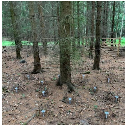
Obrázek 4.9 – Osazení senzorů i s ochranou klecí (autor)
