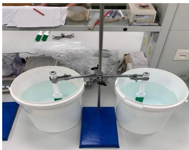
Obrázek 4.3 – Uchycení senzorů ve stojanu při měření signálu demineralizované vody (autor)
