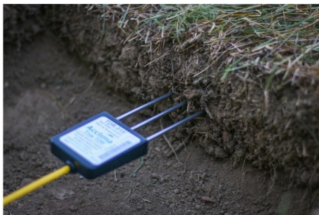
Obrázek 3.5 – Ukázka měření půdní vlhkosti se senzorem TDR (URL č.4)
