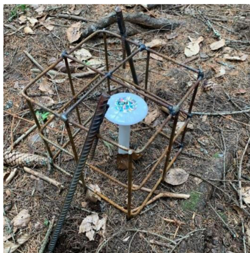
Obrázek 4.11– Detail na zabezpečení senzoru ochrannou klecí (autor)
