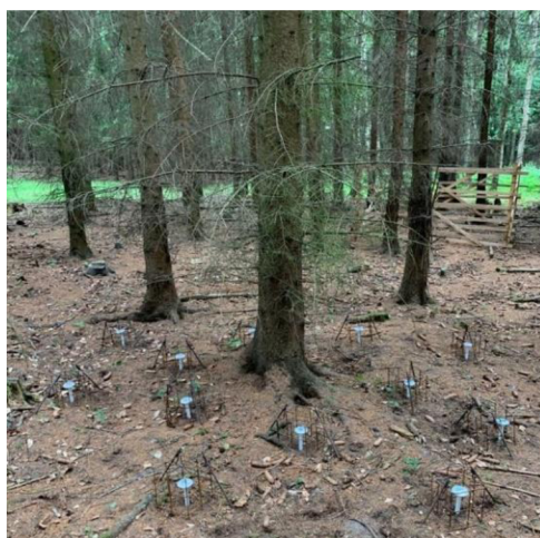
Obrázek 4.9 – Osazení senzorů i s ochranou klecí (autor)
