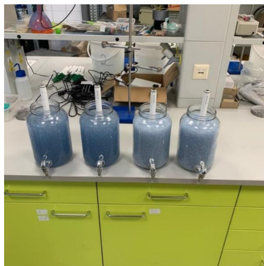
Obrázek 4.5 – Měření signálu v suchých a nasycených kuličkách (autor)
