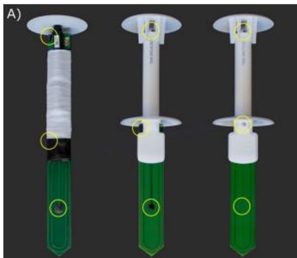
Obrázek 4.1 – Srovnání různých verzí zařízení TMS. TMS1 – vlevo, TMS3 – uprostřed, TMS4- vpravo, polohy teplotních čidel jsou označené žlutými kroužky (Wild et al., 2019)
