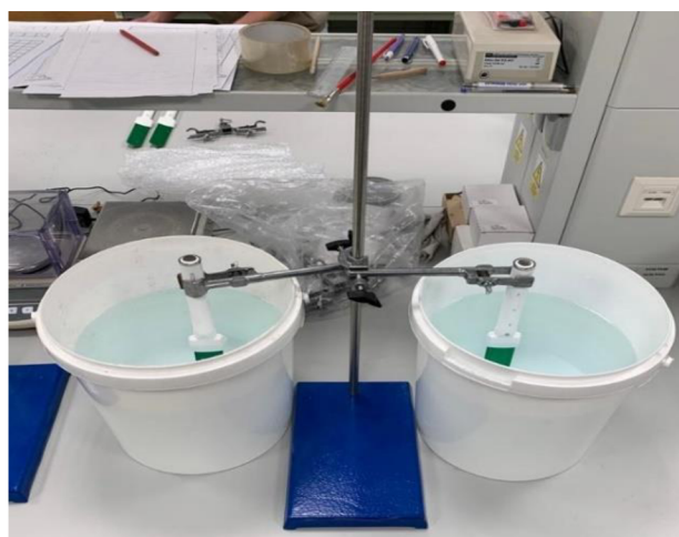
Obrázek 4.3 – Uchytní senzorů ve stojanu při měření signálu demineralizované vody (autor)
