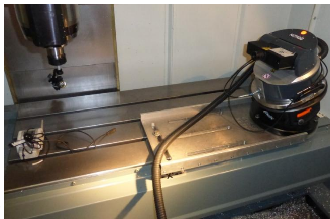
Obr. 3.18 Měřící pozice 3, pozice v Trac-Calu a skutečná pozice na stroji
