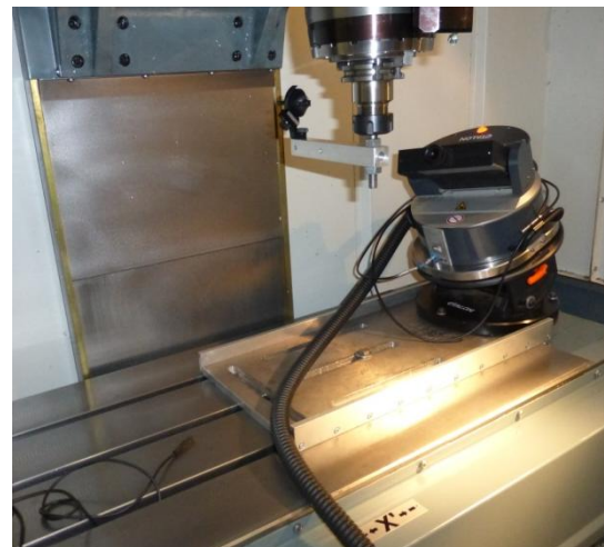
Obr. 3.20 Měřící pozice 5, pozice v Trac-Calu a skutečná pozice na stroji
