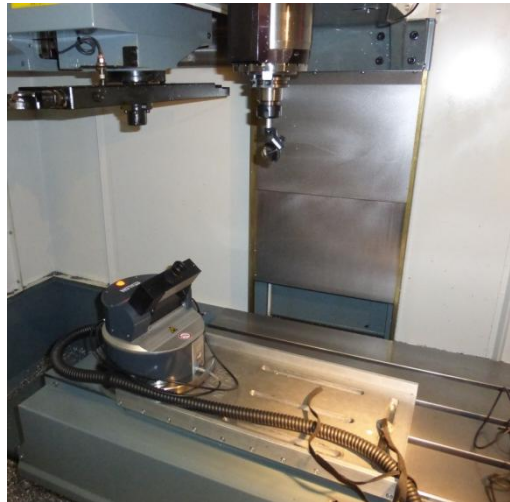
Obr. 3.16 Měřící pozice 1, pozice v Trac-Calu a skutečná pozice na stroji
