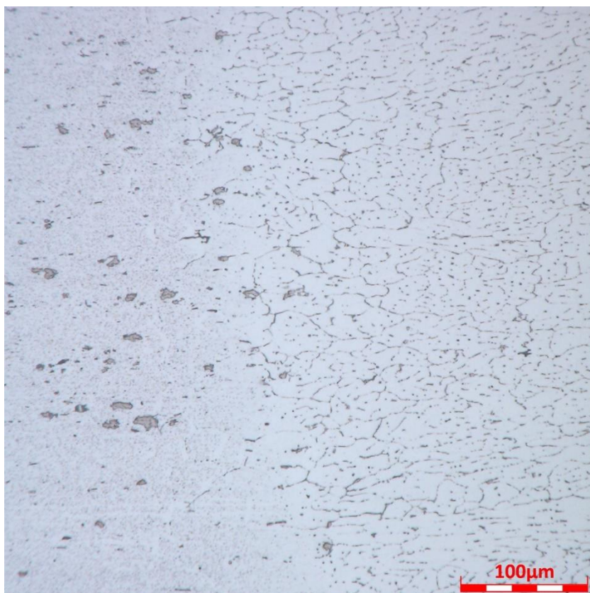
Obr. 48 Detail struktury přechodové oblasti – vzorek č.8 (laser-TIG 60A)
