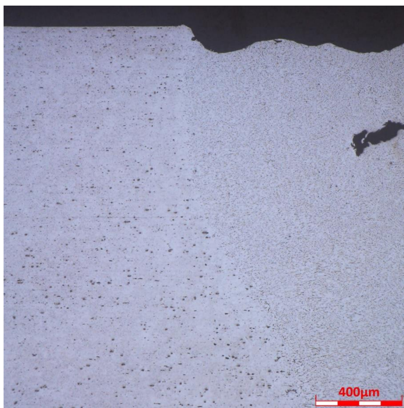
Rozhraní svarového kovu a TOO – vzorek č.3 (laser-TIG 40A)
