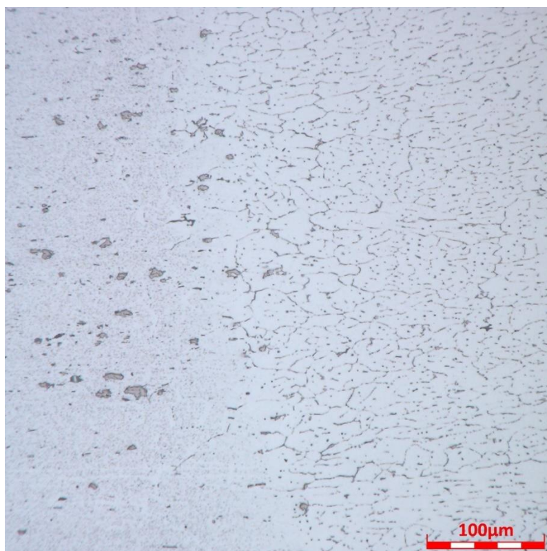
Obr. XX Detail struktury přechodové oblasti – vzorek č.8 (laser-TIG 60A)
