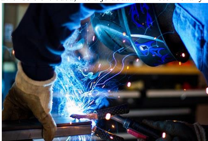
Obr. 6 Svařovací metoda MIG [19]
