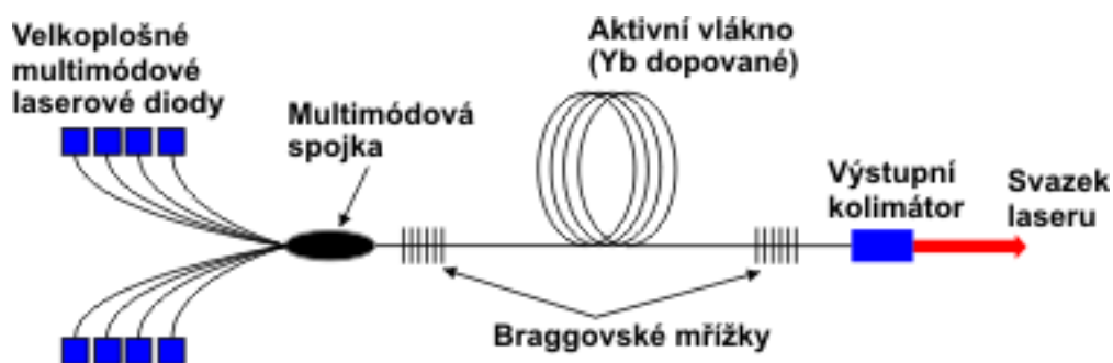
Obr. 12 Princip vlákňového laseru. [36]
