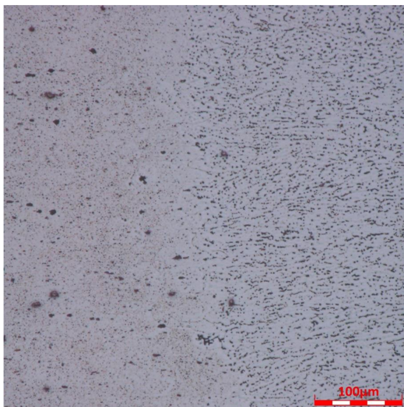
Detail struktury přechodové oblasti – vzorek č.3 (laser-TIG 40A)
