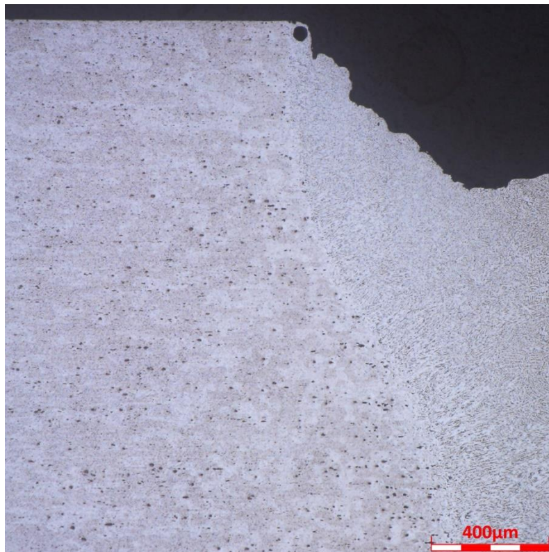
Rozhraní svarového kovu a TOO – vzorek č.1 (laser)
