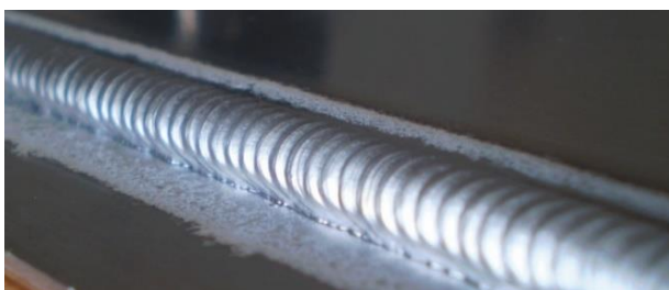
Obr. 21 Ukázka penízkové svaru. [43]
