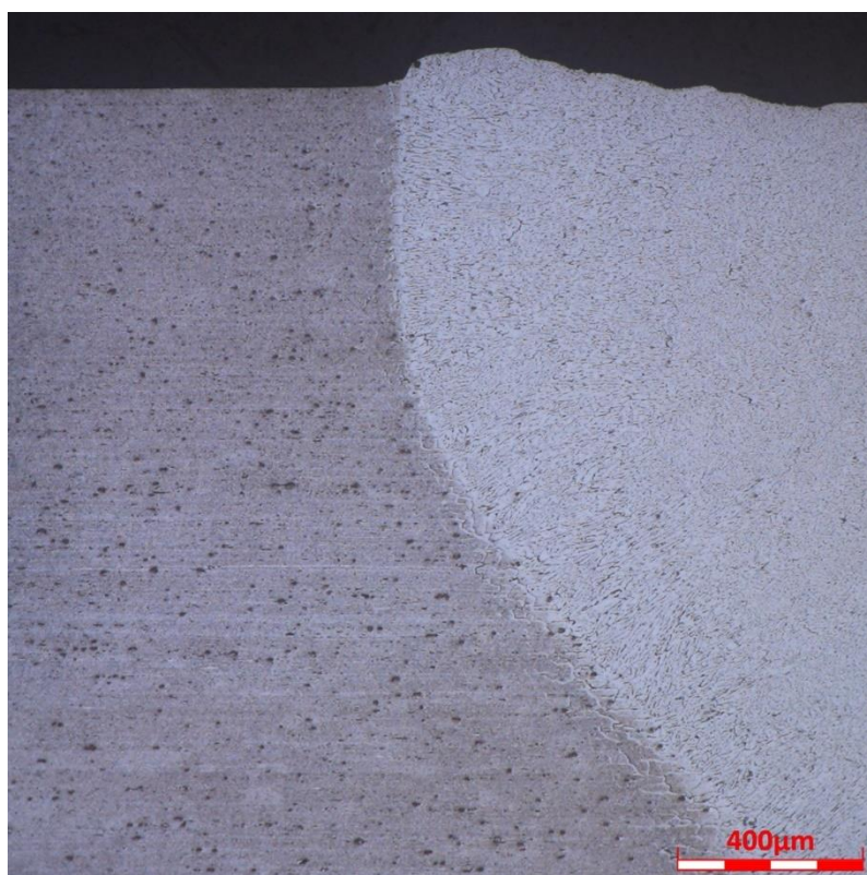
Rozhraní svarového kovu a TOO – vzorek č.6 (laser-TIG 20A)
