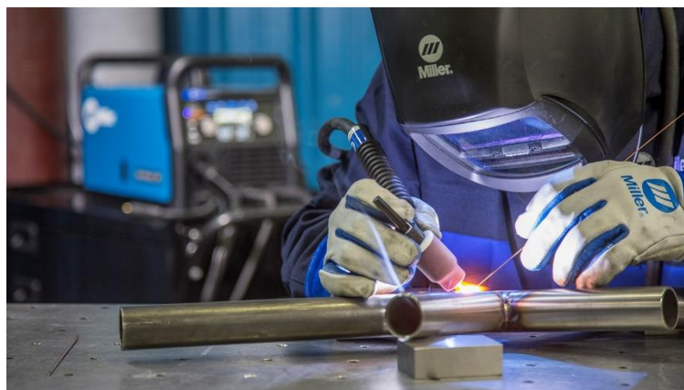
Obr. 7 Svařovací metoda TIG [20]
