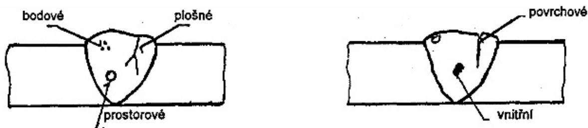
Obr.28 Typy vad ve svarech. [55]
