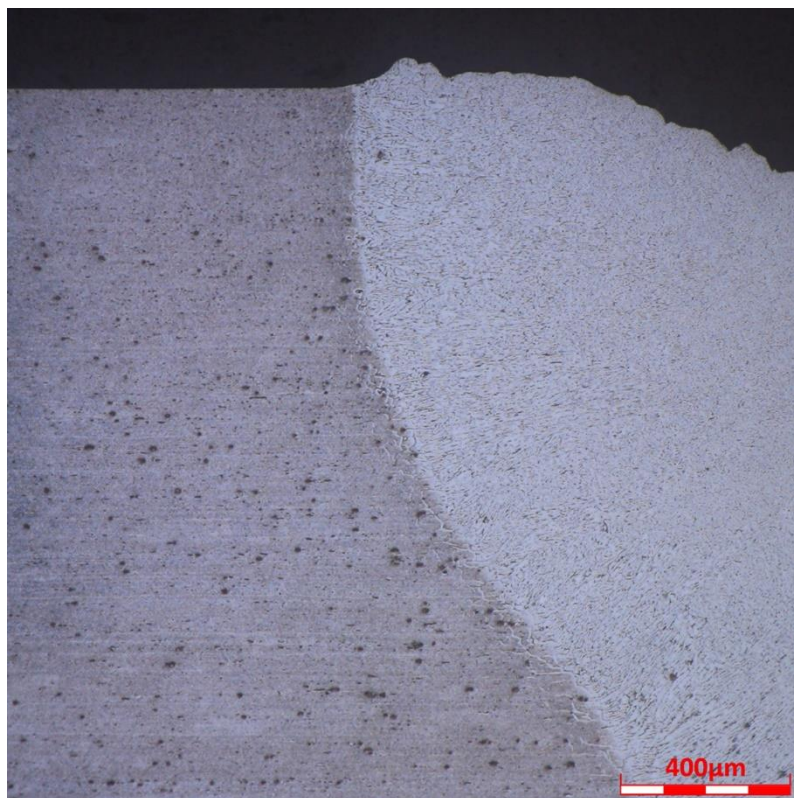
Rozhraní svarového kovu a T6O – vzorek č.5 (laser)
