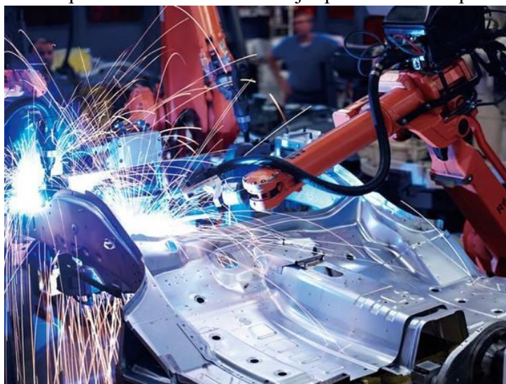
Obr. 8 Laserové svařování karosérie. [21]
