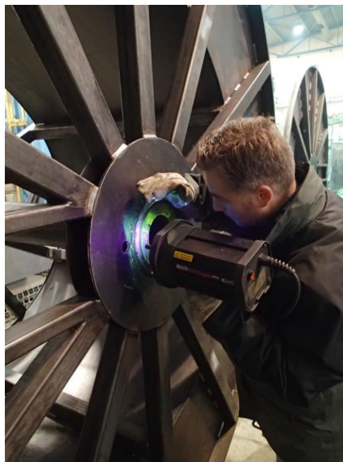
Obr. 31 Magnetická zkouška svaru [59]
