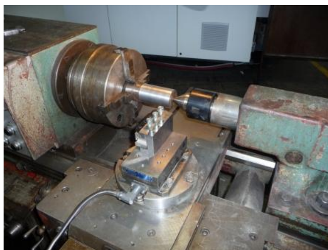
Obr. 2.2 Hrotový soustruh SU50A-SP.
