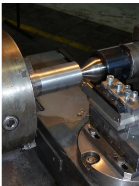
Obr. 2.5 Upnutí řezného nástroje pro měření silového zatížení.
