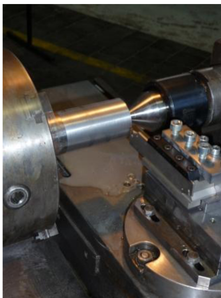
Obr. 2.5 Upnutí řezného nástroje pro měření silového zatížení.
