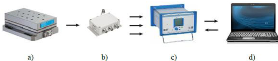
Obr. 2.4 Schéma zapojení soustavy: a) Dynamometr firmy KISTLER 9257B, b) distribuční box s BNC konektory, c) vícekanálový zesilovač typ 5070A11000, d) počítač ACER + software DynoWare 2852 A-02-2 [16]
