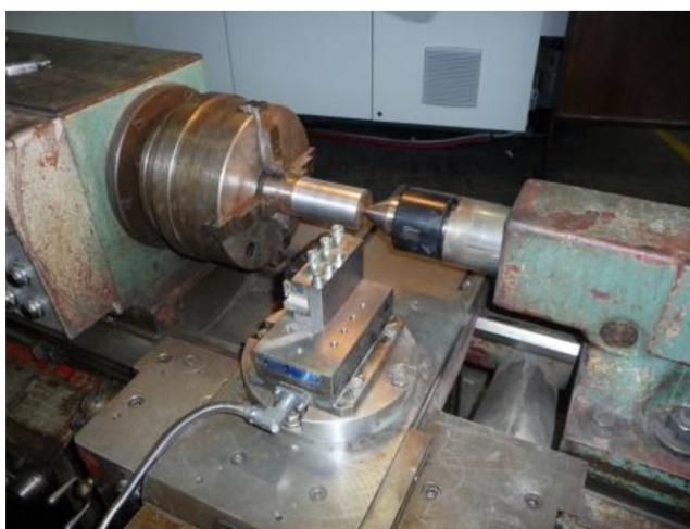
Obr. 2.2 Hrotový soustruh SU50A-SP.
