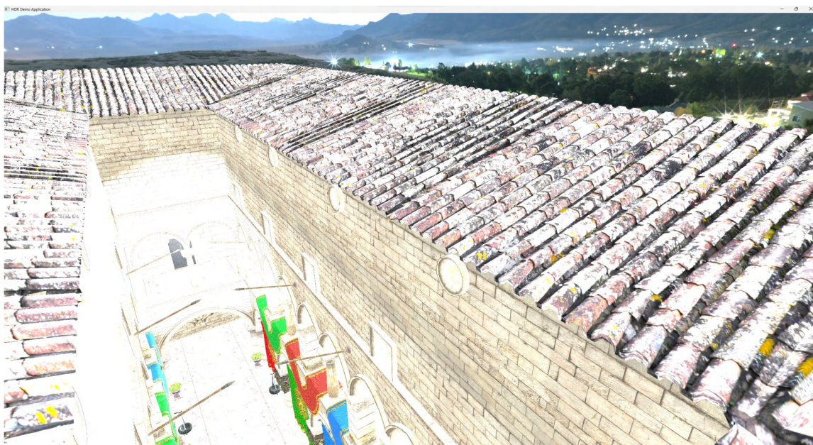
Obrázek 5.1: Výchozí scéna renderovaná s hodnotami osvětlení ve vysokém dynamickém rozsahu zobrazená na LDR displeji bez aplikování operátorů mapování tónů.
