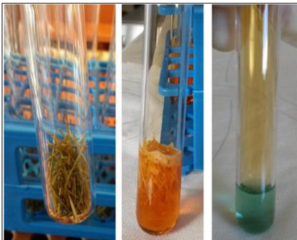
Obr. 17: Křemenné zkumavky s jehličím, v kyselině dusičné a roztokem po proběhlém rozkladu (zleva).
