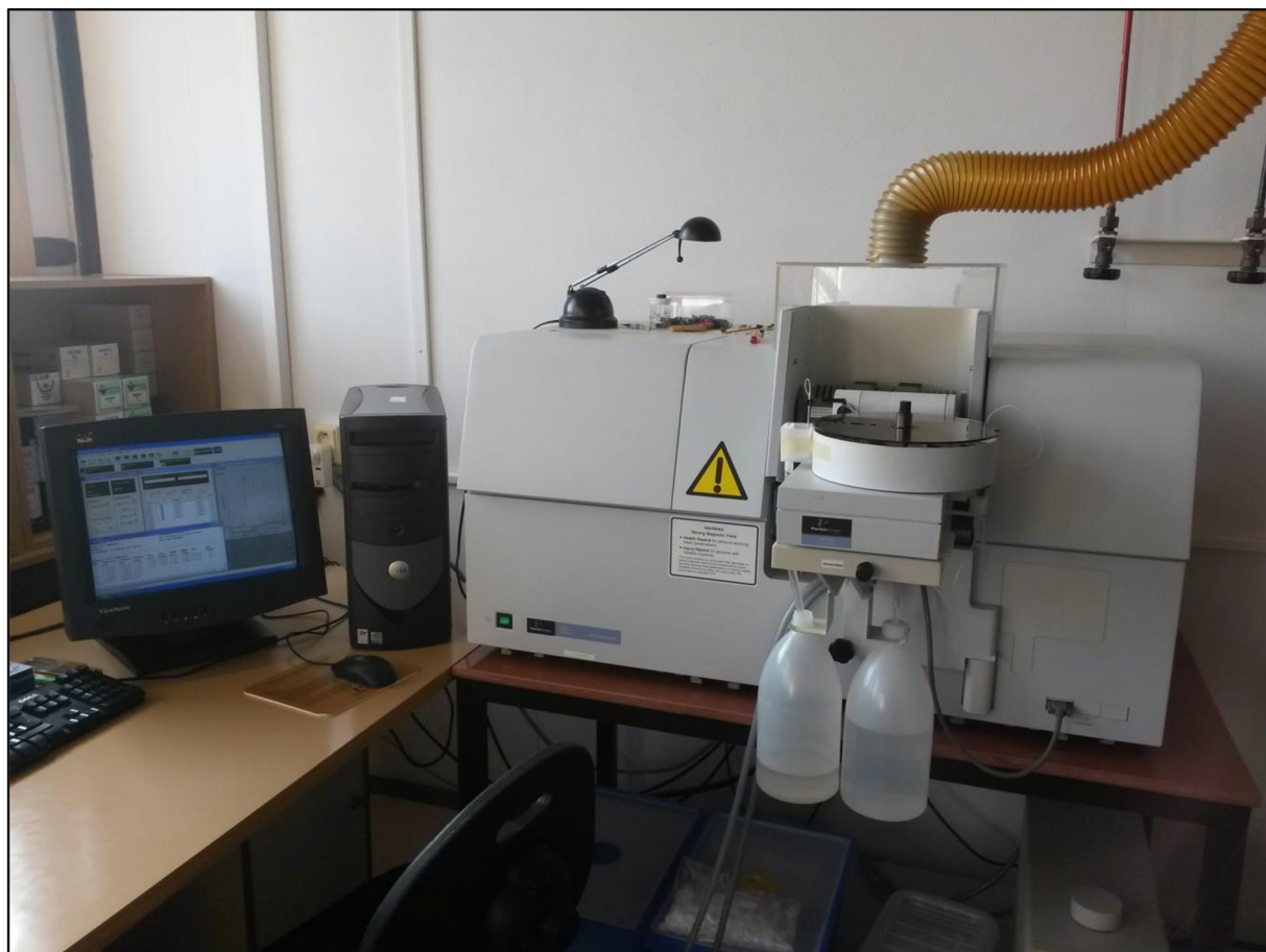
Obr. 20: Přístroj AAnalyst 600 Perkin-Elmer s příslušenstvím.
