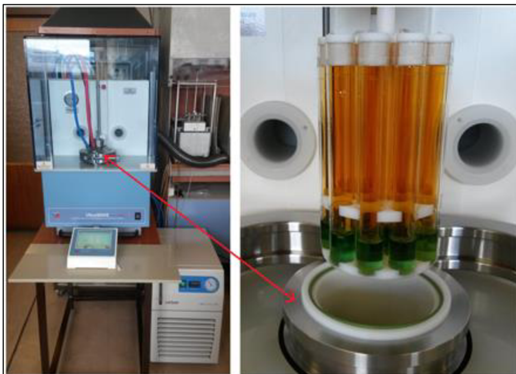
Obr. 15: Tlakový mikrovlnný mineralizátor a zkumavky s mineralizovaným jehličím.
