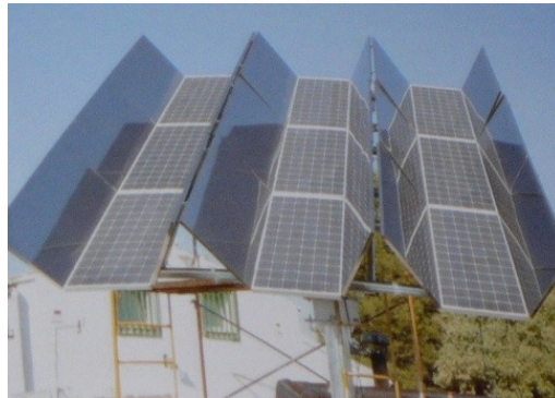
Obr. V Fotovoltaický systém se žlabovým koncentrátorem s rovinným zrcadlem
