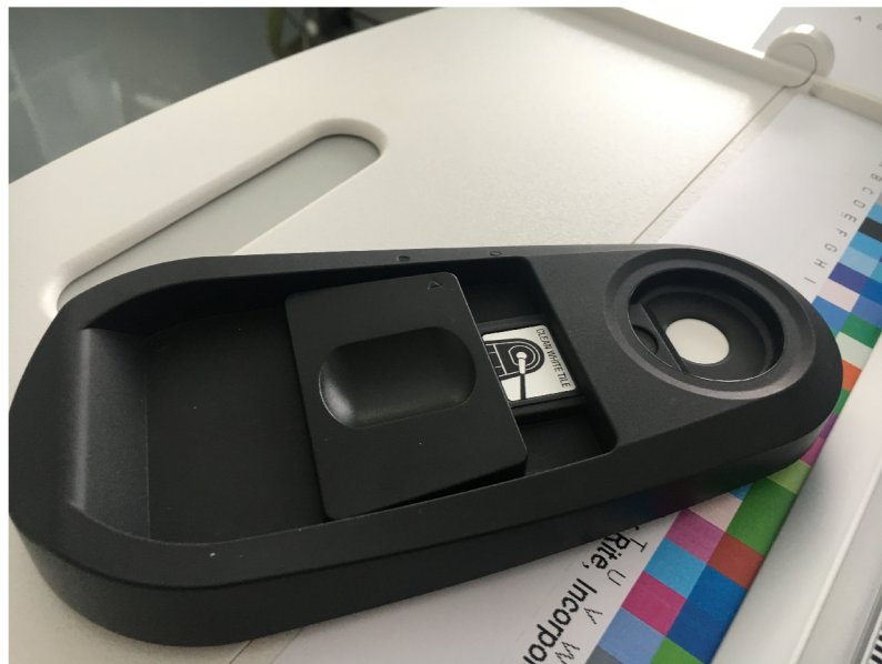
Obr. 1.16: i1 pro sonda - Bílý terč pro kalibraci [17]
