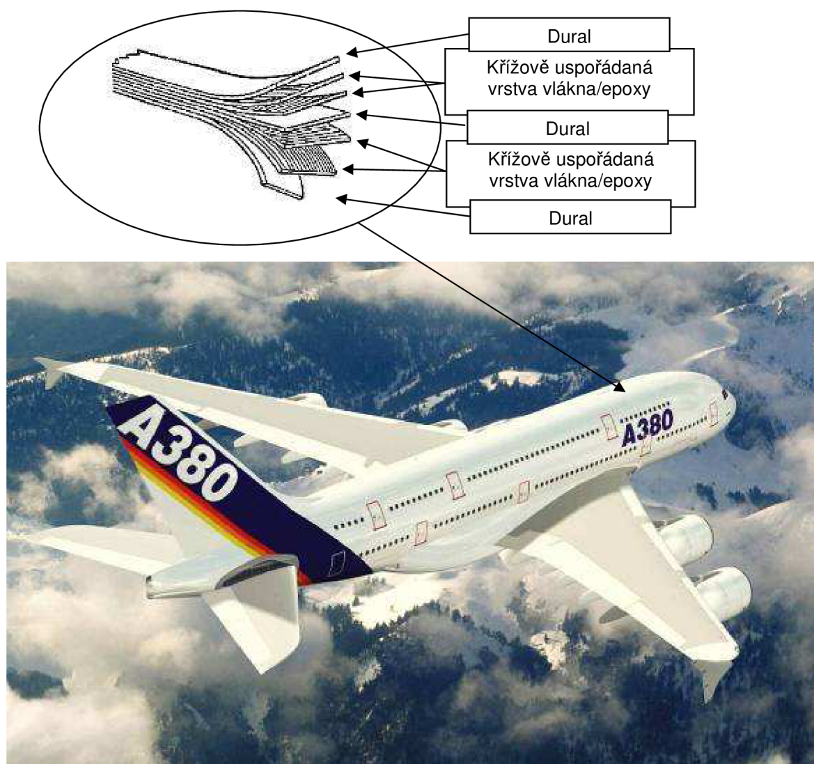
Obr. 1.1: Využití VKL u obřího A380 a základní morfologie VKL (ilustrační foto)
