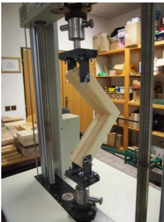
Obr. 27 - Zkoušení rohového spoje (Podlena and Borůvka, 2016)
