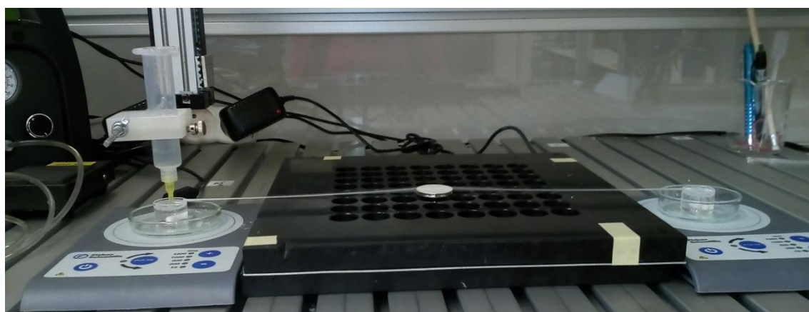
Obrázek 22: Mikromanipulátor II s modifikací tažení vláken z volné hladiny
