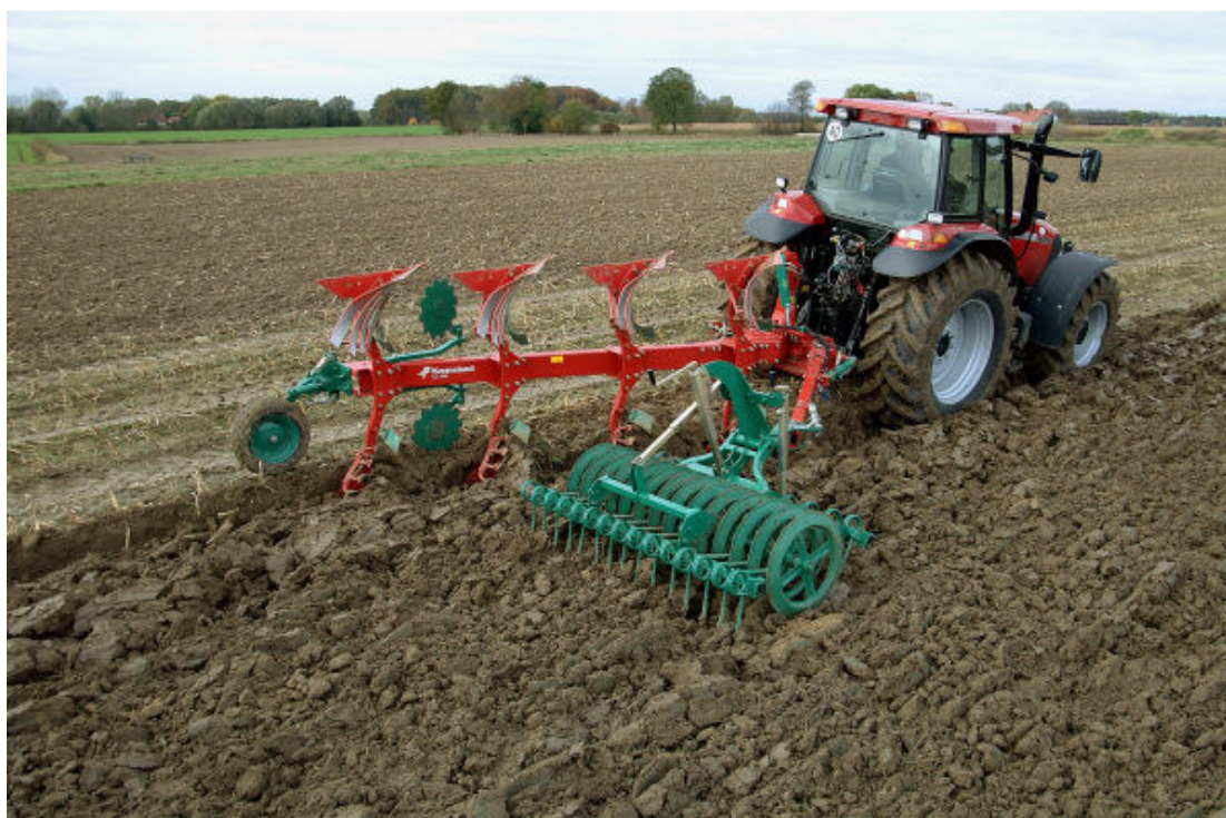
Obr. 4 Orba oboustranným čtyřradličným pluhem s použitím hrudořezu
