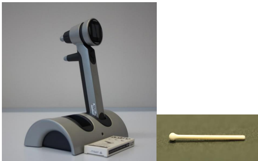
Obr. 10: Tonometr Icare Pro ® TAO1 a detail sondy.
