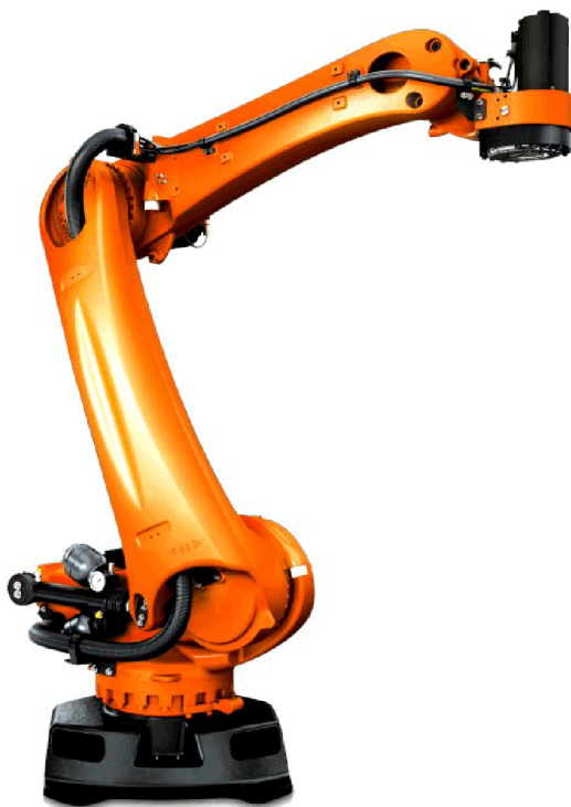
Obrázek 3.3 Průmyslový robot KUKA [13]
