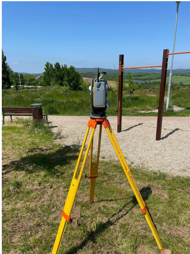
Obrázek 4 - Totální stanice Trimble S7
