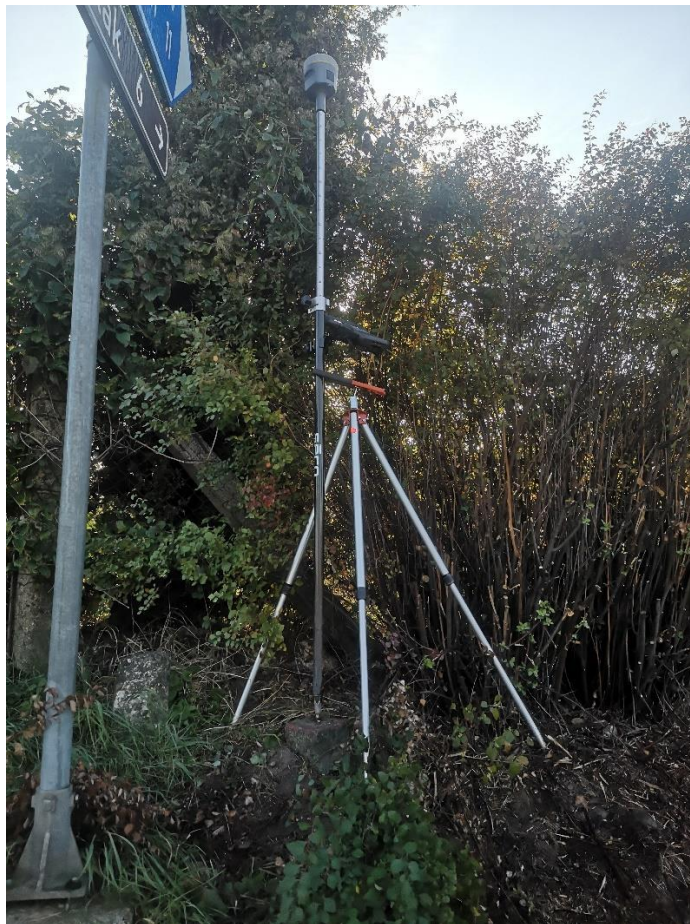
Obrázek 5 – Trimble R12i GNSS nad bodem 00000044092040
