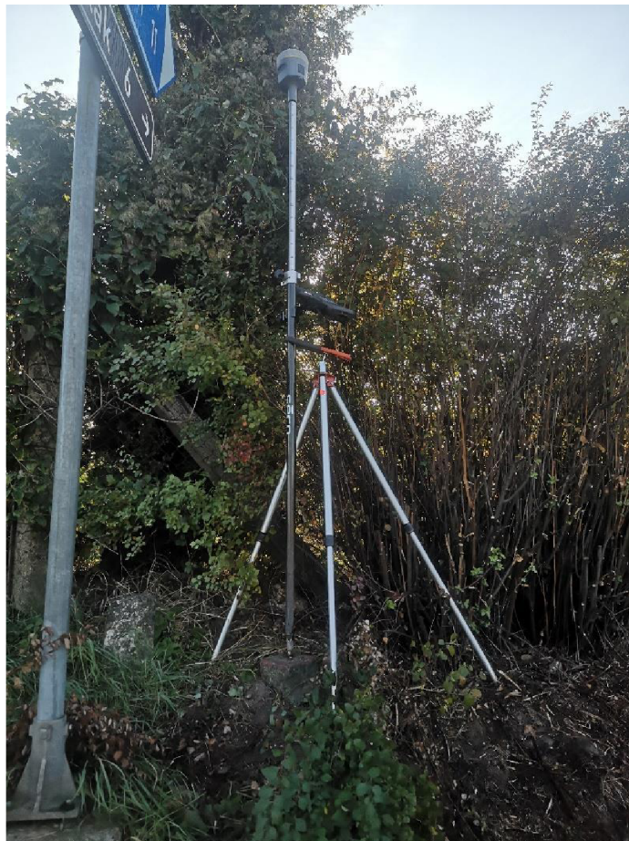
Obrázek 5 – Trimble R12i GNSS nad bodem 00000044092040
