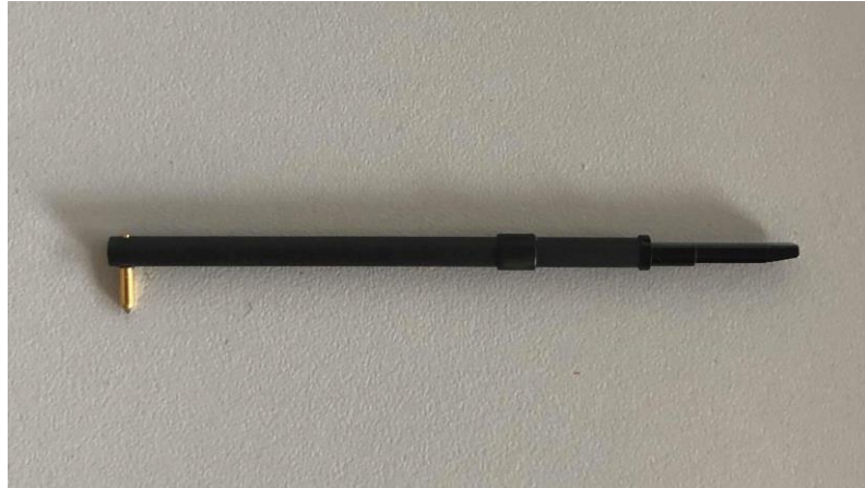
Obrázek 23: Raménko kontaktního profilometru obsahující kuželový diamantový hrot (Autor, 2019)
