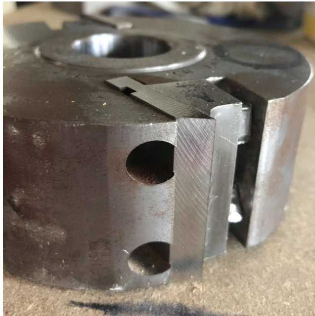
Obrázek 17: Frézovací hlava s detailem na nůž (Autor, 2019)
