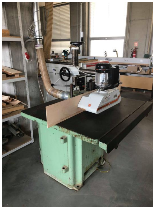
Obrázek 19: Spodní jedno-vřetenová frézka (Autor, 2019)
