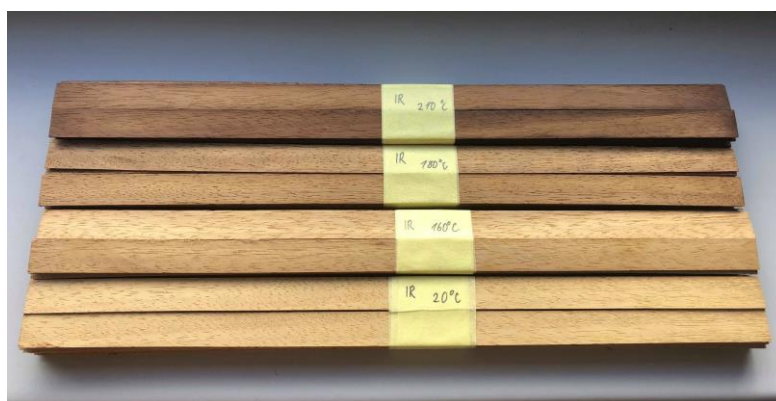
Obrázek 16: Vzorky dřeva iroko rozdělené podle stupně termické úpravy (Autor, 2019)
