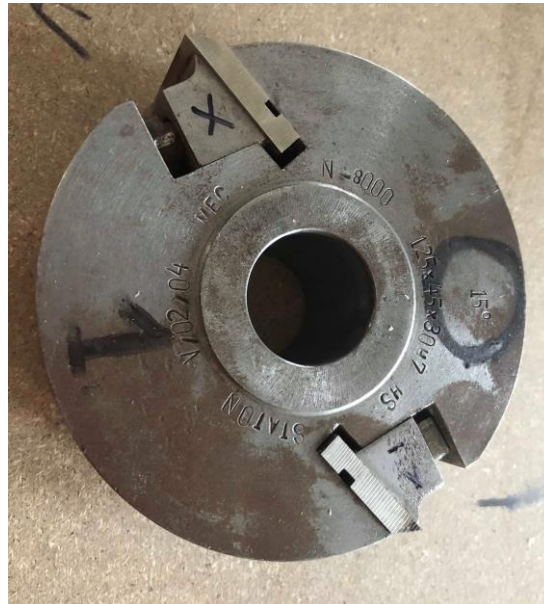
Obrázek 18: Použitá frézovací hlava (Autor, 2019)
