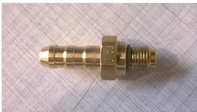
Obr. 19 Kalibrační trysky vstřikovače \varnothing 2,4 mm
