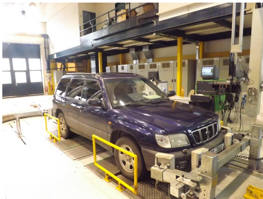
Obr. 17 Ukotvení vozidla na válcích
