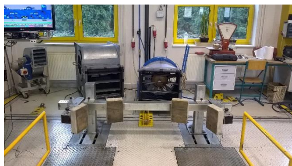
Obr. 13 Ventilátory náporového chlazení
