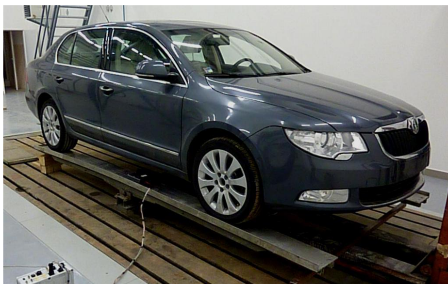
Obrázek 19 Zařízení pro měření momentu setrvačnosti kolem svislé osy na ÚADI [18]
