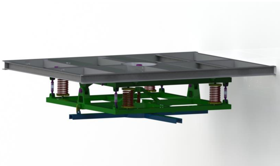
Obrázek 20 Stávající zařízení na ÚADI pro měření momentů setrvačnosti kolem tří navzájem kolmých os [7]
