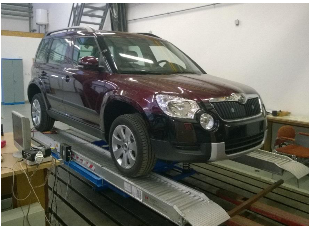
Obrázek 34 Měření výškové polohy těžiště pomocí pitch motion
