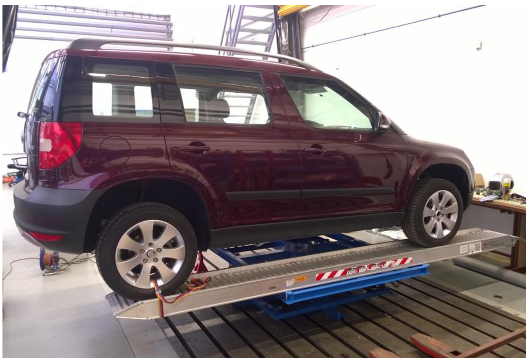
Obrázek 35 Měření výškové polohy těžiště pomocí roll motion
