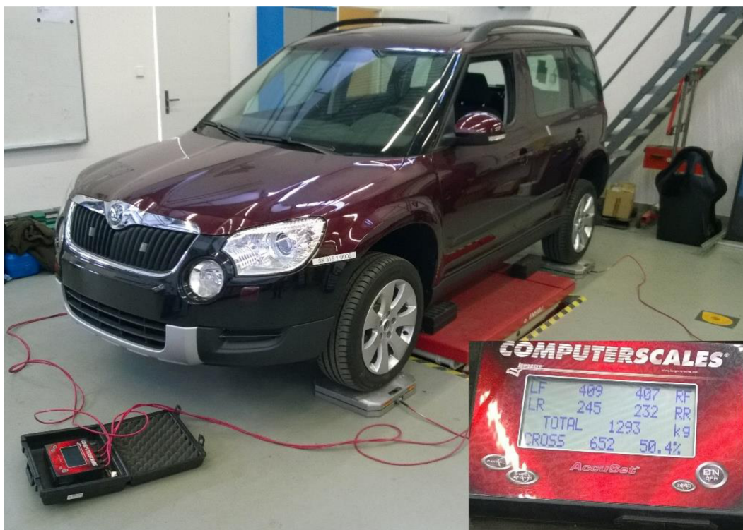
Obrázek 33 Měření hmotnosti vozidla na čtyřech vahách
