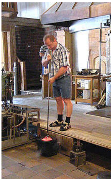
Obrázek 15: Foukání do dřevěné formy [25]
