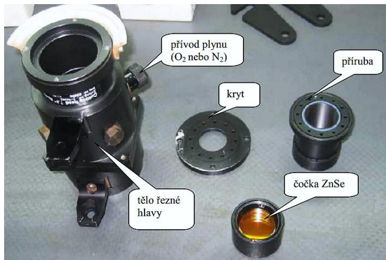
Obr. 34 Základní části laserové řezací hlavy [18].
