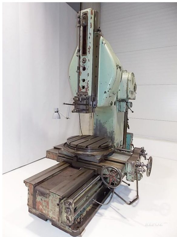
Obr. 29 Svislá obrážecí stroj [15].
