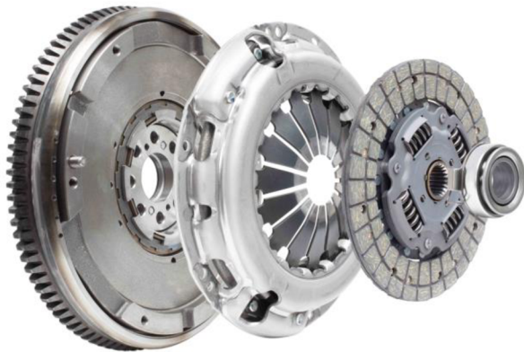
Obr. 40 Třecí automobilová spojka [25].
