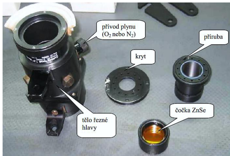
Obr. 34 Základní části laserové řezací hlavy [18].
