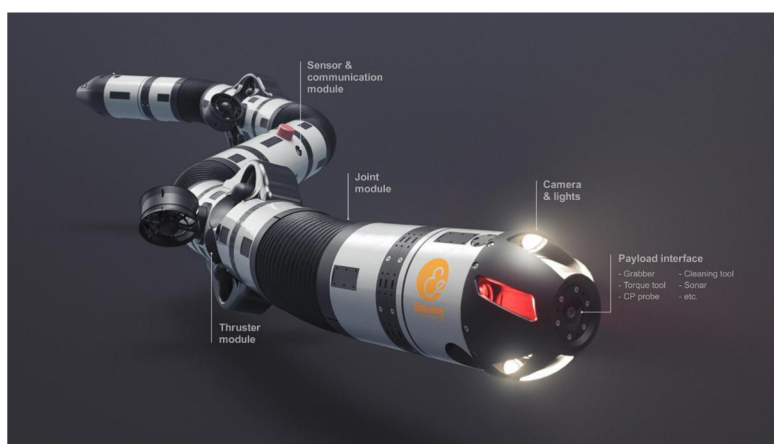
Obr. 17 Eelume (podvodný robot) [19]
